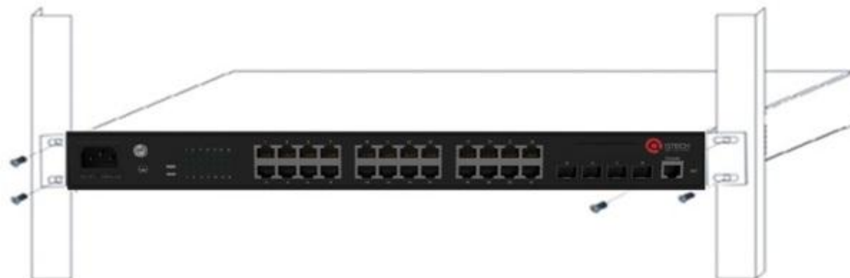
Установка коммутатора в стойку
