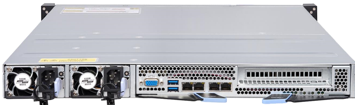
Рисунок 1. Серверная платформа QSRV-130404 (Вид сзади)
