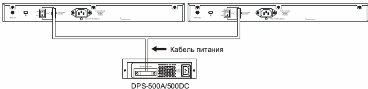
Рисунок 10 — Подключение двух коммутаторов к DPS-500A/500DC
