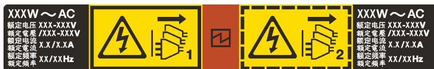
Рис. 228. Этикетка оперативно заменяемого блока питания на крышке
