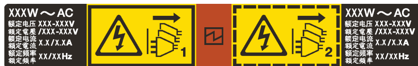
Рис. 38. Этикетка оперативно заменяемого блока питания на крышке
