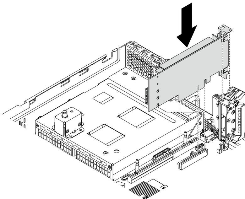
Рис. 53. Установка адаптера PCIe на материнскую плату
