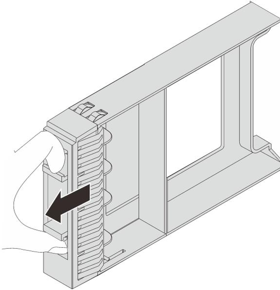
Рис. 66. Снятие заглушки 2,5-дюймового диска
