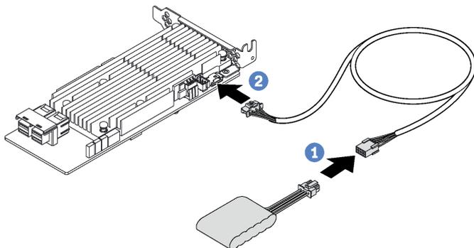
Рис. 63. Подключение модуля суперконденсатора RAID к адаптеру RAID
