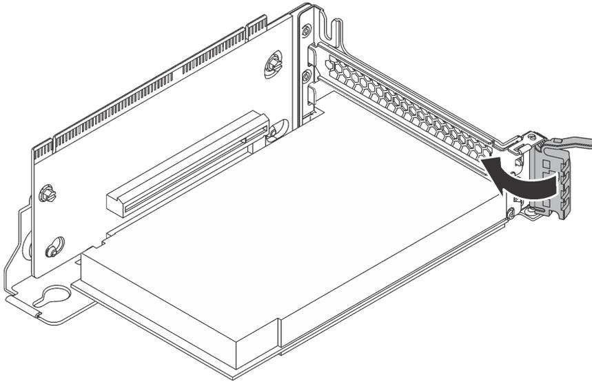
Рис. 50. Закрывание фиксирующей защелки PCIe
