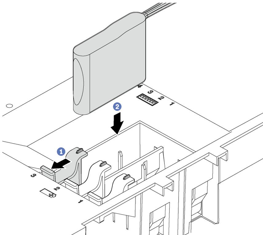
Рис. 62. Установка модуля суперконденсатора RAID
