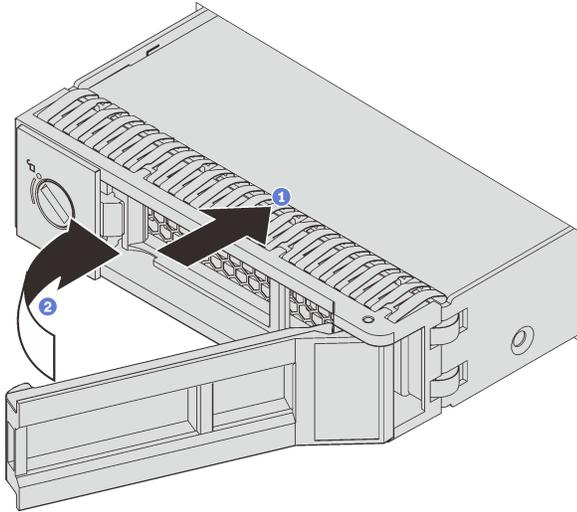
Рис. 71. Установка диска с обычной заменой
