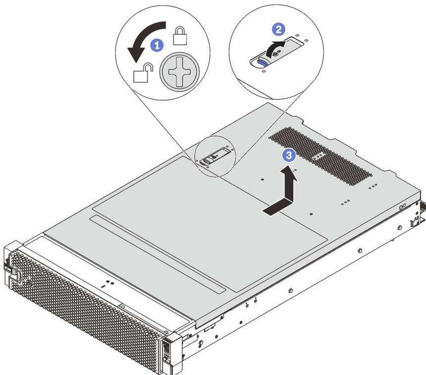
Рис. 31. Снятие верхнего кожуха
