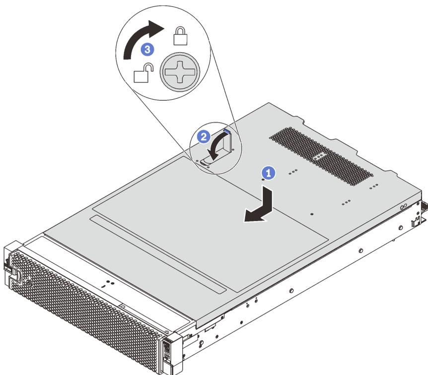
Рис. 64. Установка верхнего кожуха
