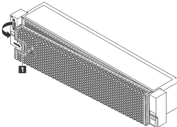
Рис. 30. Снятие защитной панели
