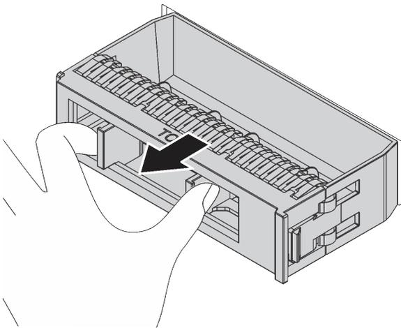
Рис. 67. Снятие заглушки 3,5-дюймового диска
