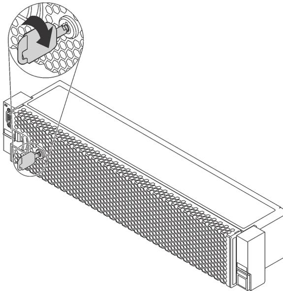
Рис. 29. Разблокирование защитной панели
