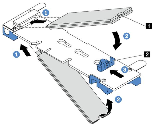
Рис. 44. Установка диска M.2
