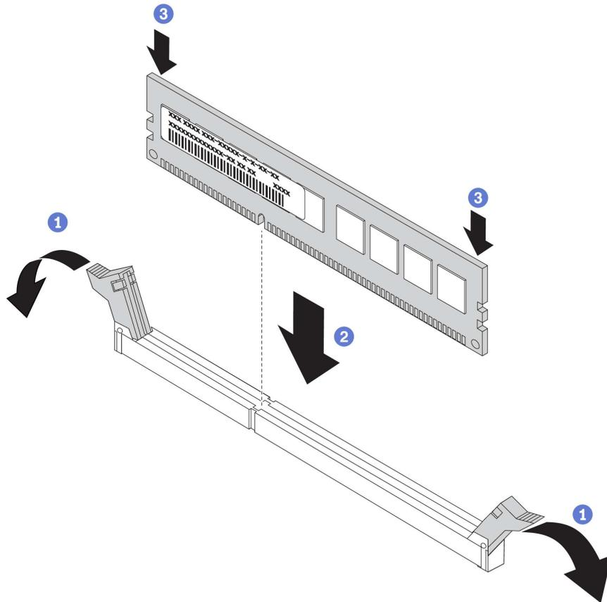
Рис. 35. Установка модуля памяти
