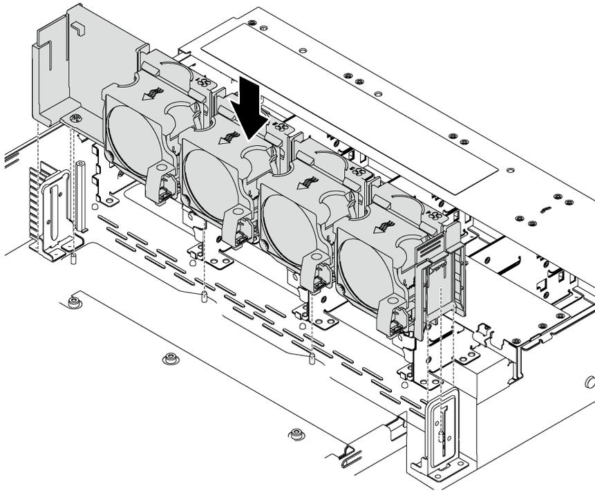
Рис. 56. Установка отсека вентиляторов компьютера
