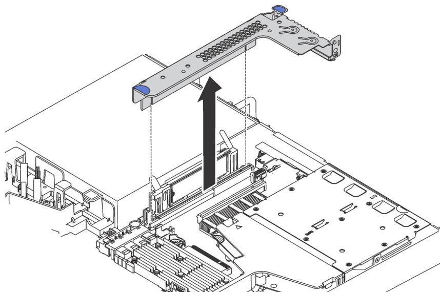
Рис. 109. Снятие блока платы-адаптера Riser
