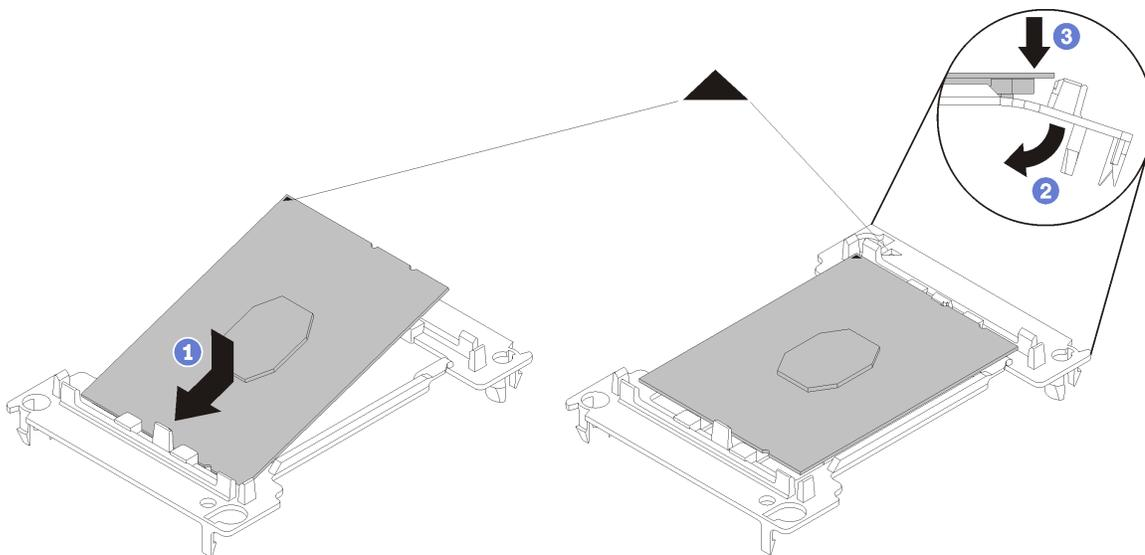
Рис. 148. Установка фиксатора процессора, не являющегося процессором IFT
