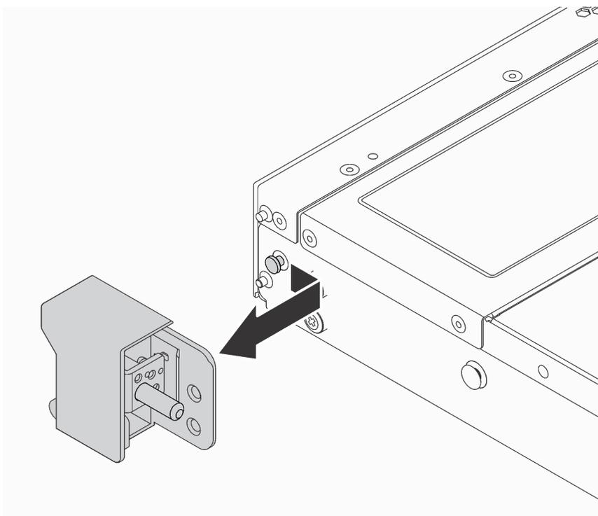
Рис. 52. Снятие защелки стойки
