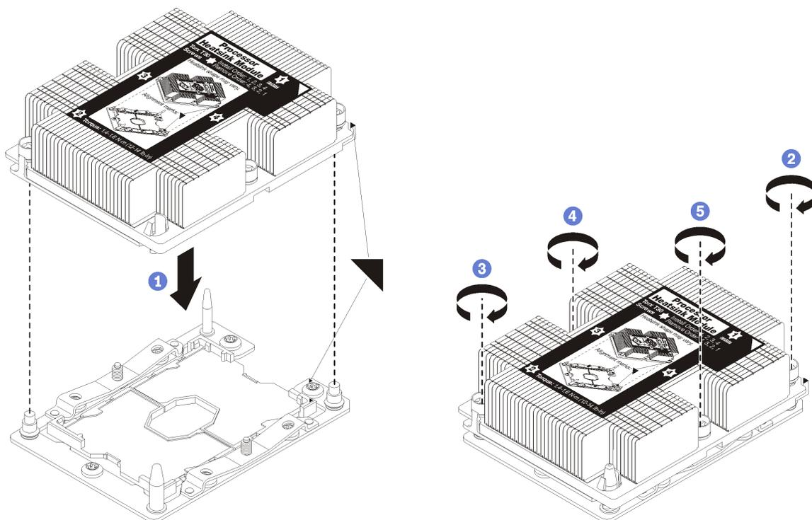
Рис. 153. Установка модуля РНМ
