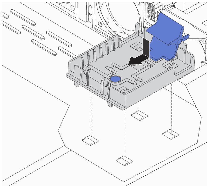
Рис. 128. Установка держателя модуля суперконденсатора RAID
