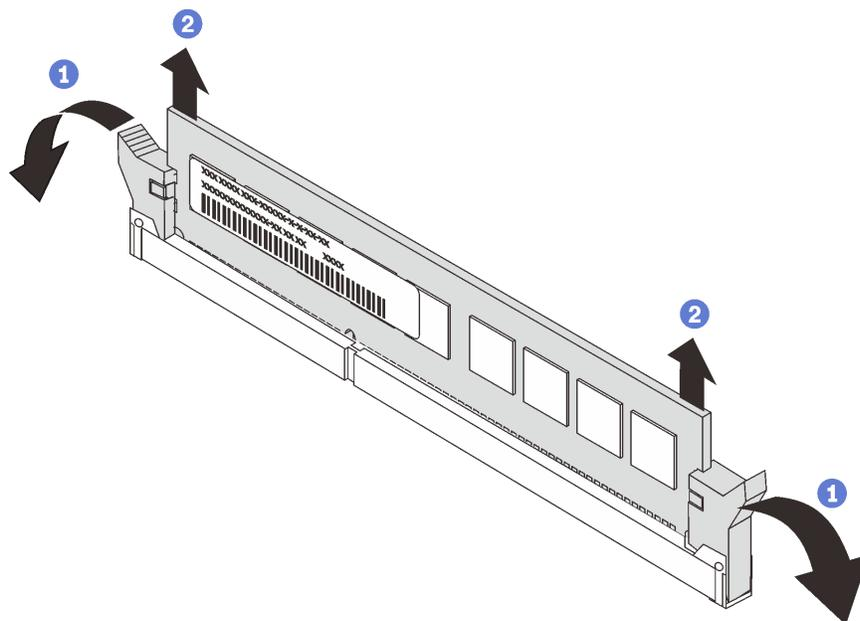
Рис. 63. Снятие модуля памяти
