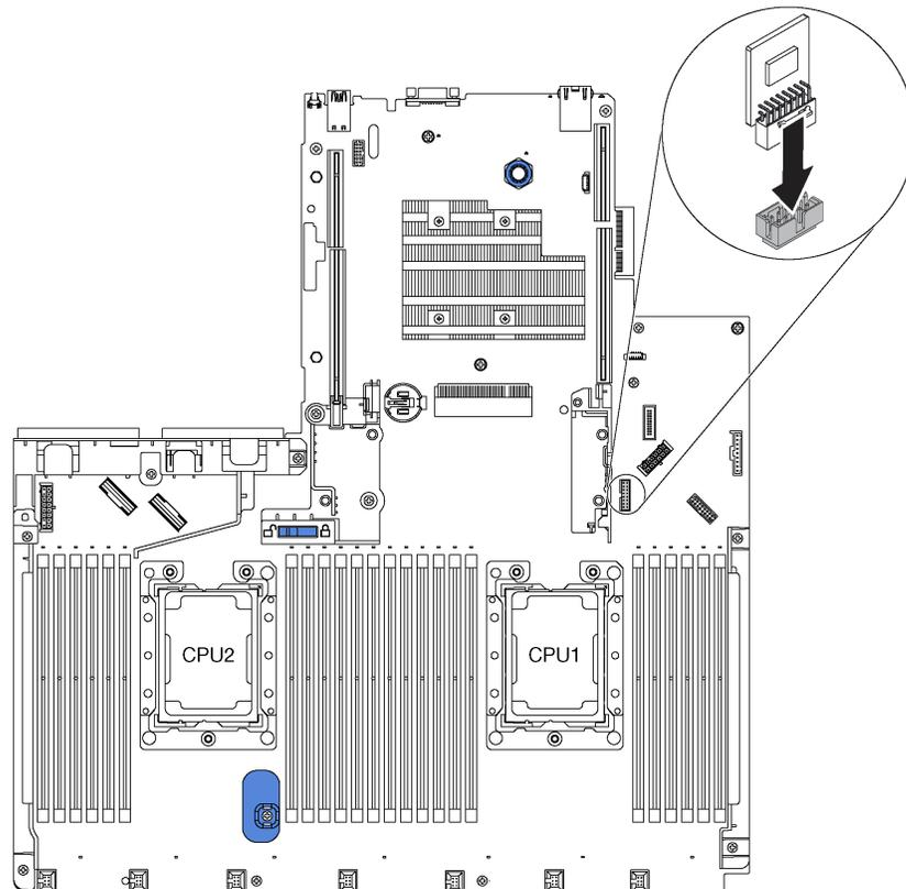
Рис. 101. Установка адаптера TSM/TPM
