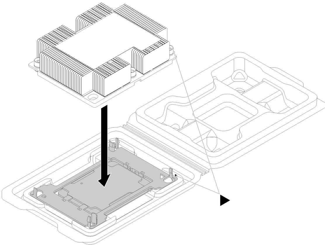
*Рис. 151. Сборка модуля процессора с радиатором (PHM) в транспортном лотке*
