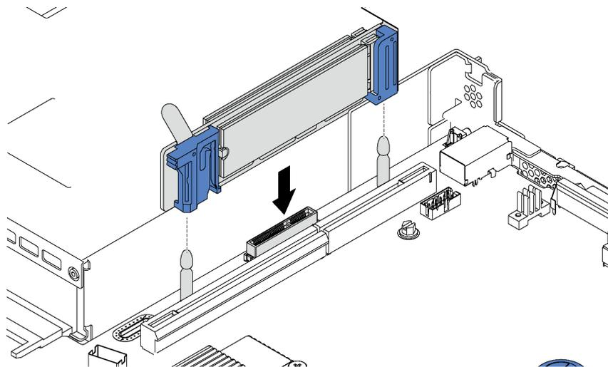
Рис. 120. Установка соединительной панели M.2
