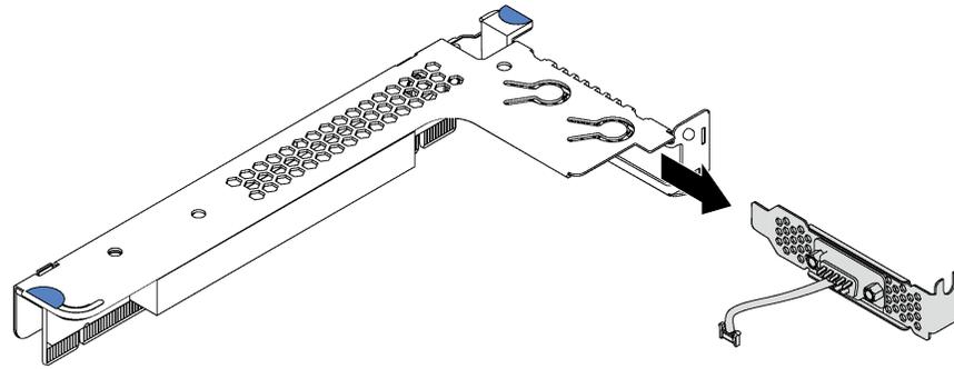
Рис. 110. Извлечение модуля последовательного порта
