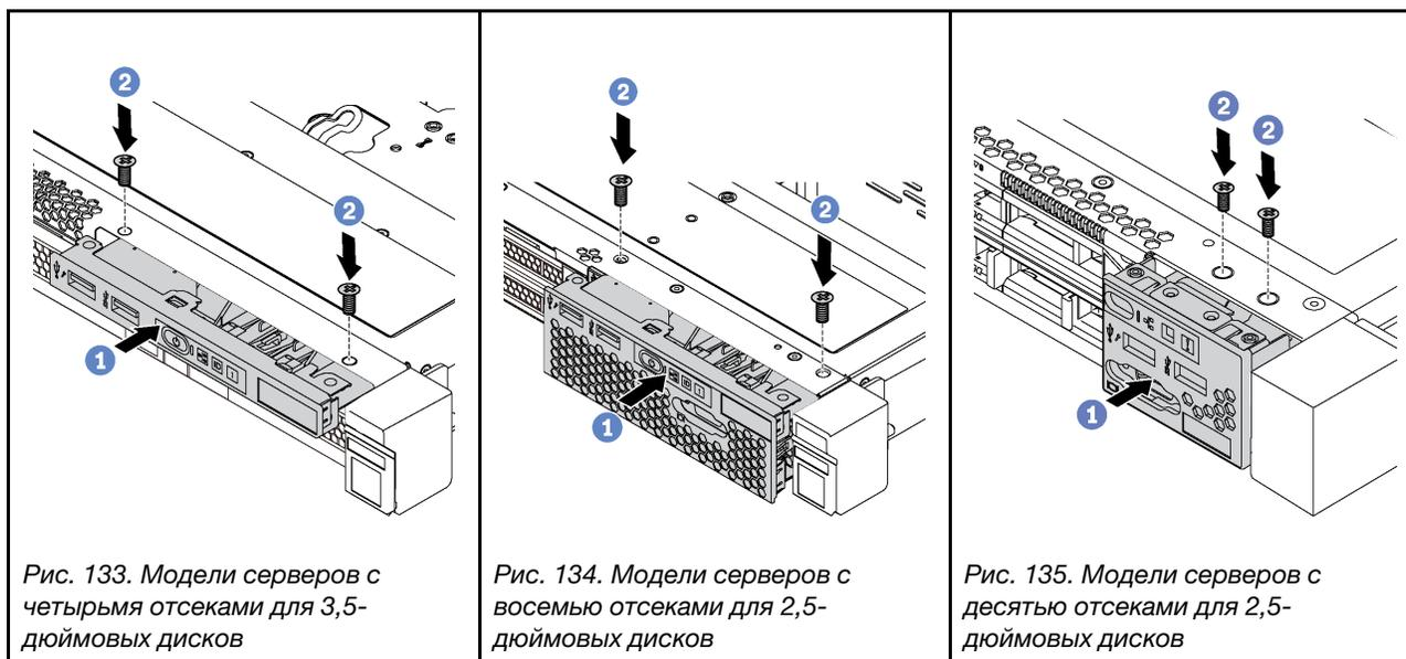
Шаг 1. Вставьте передний блок ввода-вывода в отсек для блоков.
