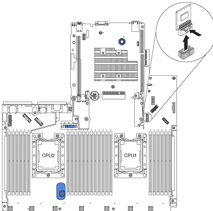
Рис. 100. Снятие адаптера TSM/TPM
