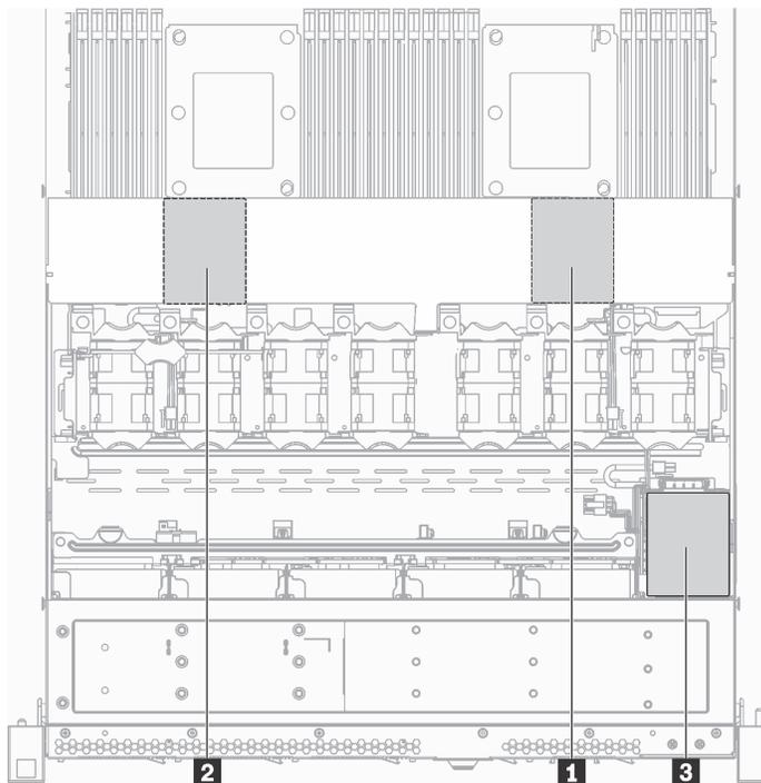
Рис. 122. Местоположение модуля суперконденсатора RAID
