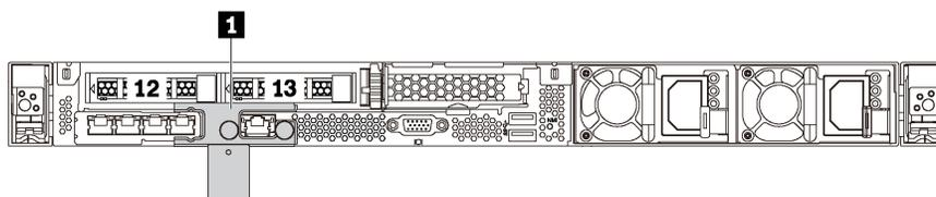
Рис. 14. Вид сзади моделей серверов с транспортировочной скобой
