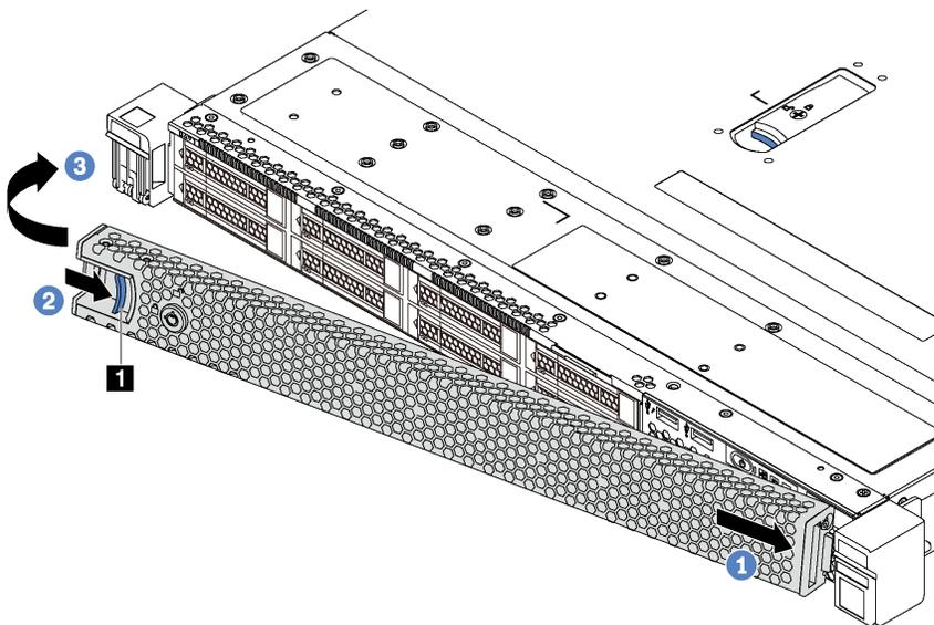
Рис. 59. Установка защитной панели
