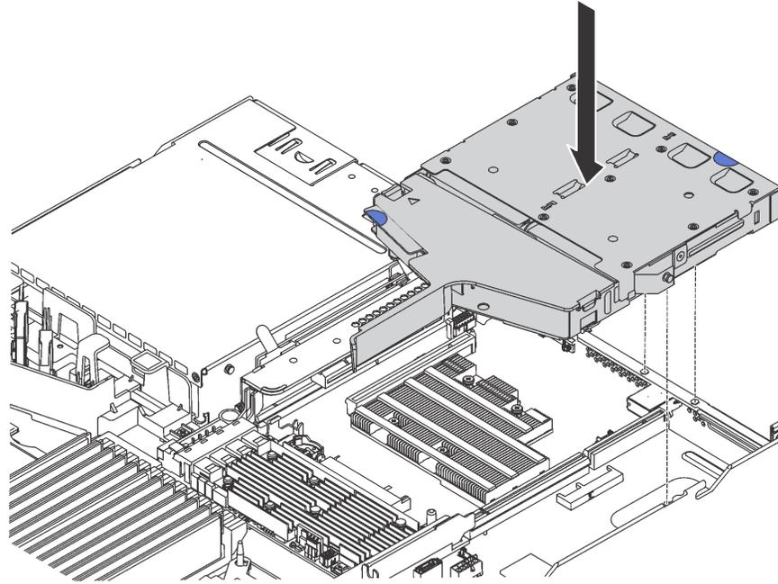
Рис. 106. Установка заднего блока оперативно заменяемых дисков
