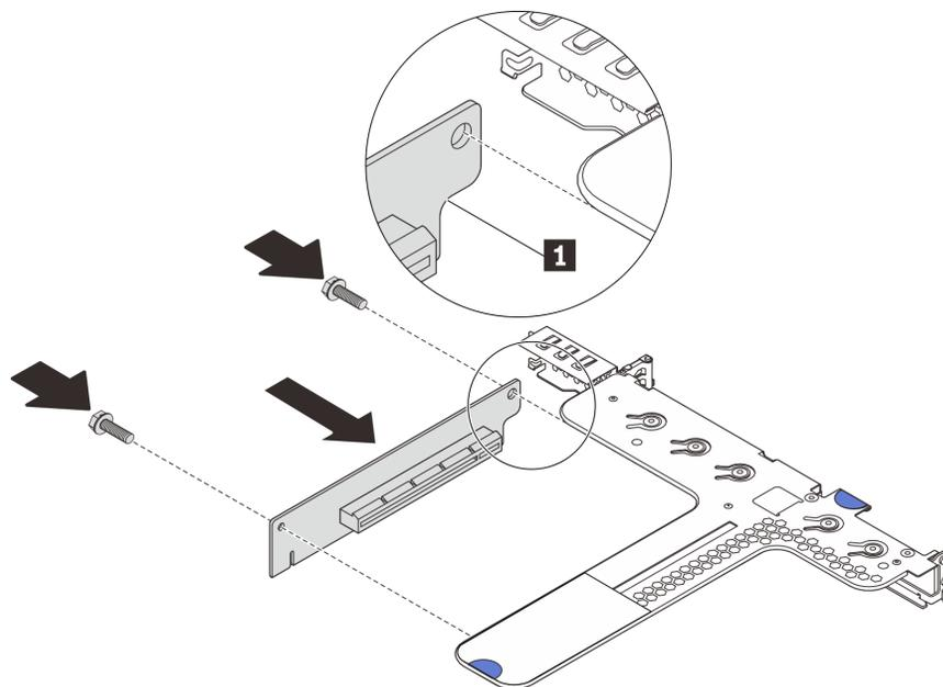
Рис. 78. Установка платы-адаптера Riser
