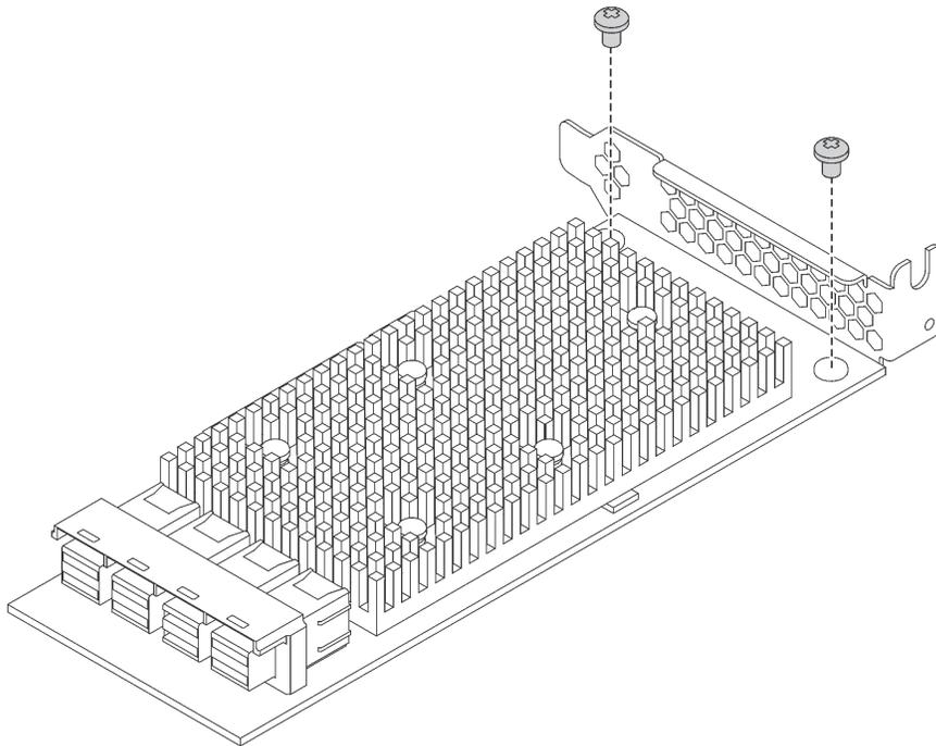
Рис. 86. Установка низкопрофильной скобы на адаптере RAID
