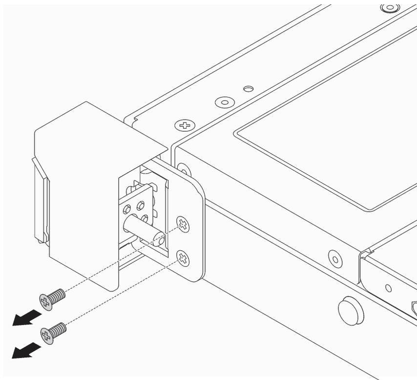
Рис. 51. Снятие винтов с защелки стойки
