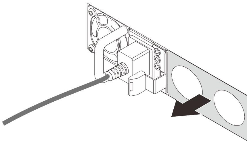
Рис. 141. Снятие заглушки оперативно заменяемого блока питания
