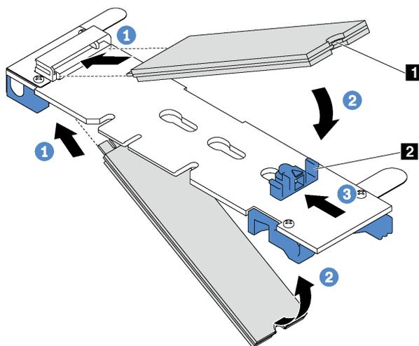
Рис. 118. Установка диска M.2
