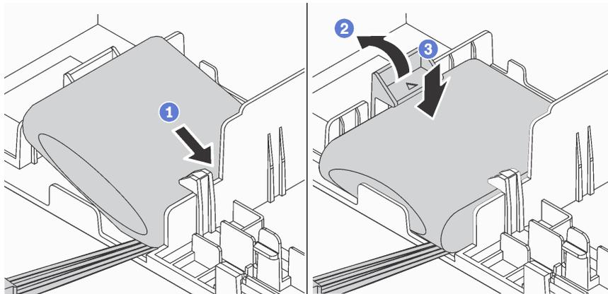
Рис. 123. Установка модуля суперконденсатора RAID в нижней части дефлектора
