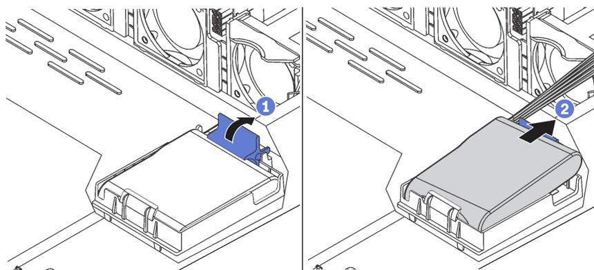
Рис. 124. Снятие модуля суперконденсатора RAID с рамы
