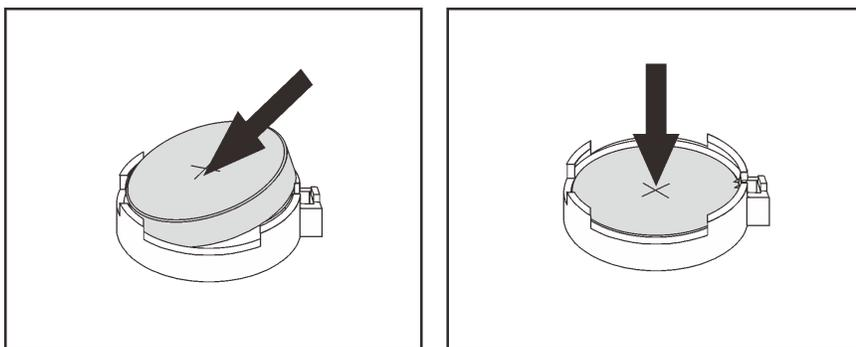
Рис. 99. Установка батарейки CMOS
