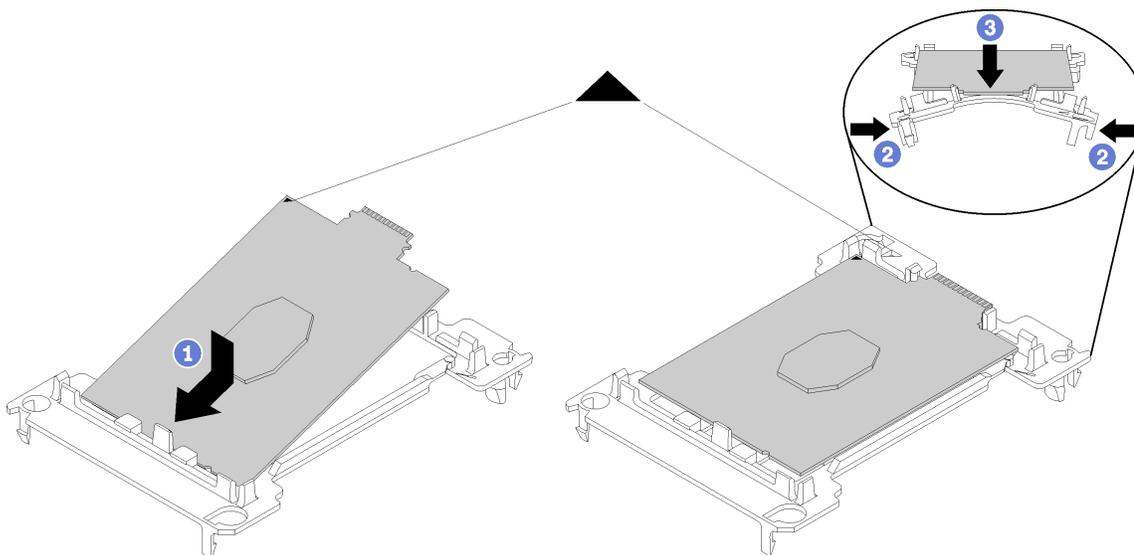
Рис. 149. Установка фиксатора процессора IFT
