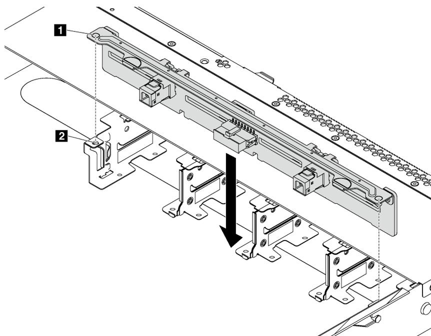
Рис. 90. Установка объединительной панели для восьми 2,5-дюймовых оперативно заменяемых дисков
