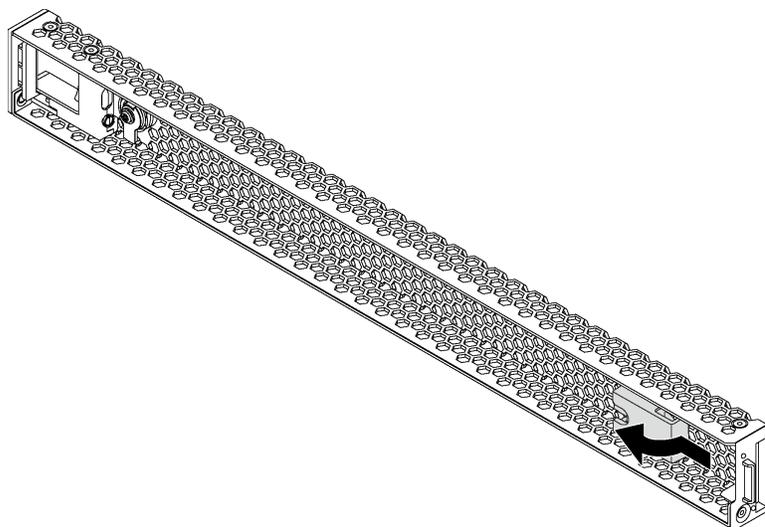
Рис. 58. Снятие ключа
