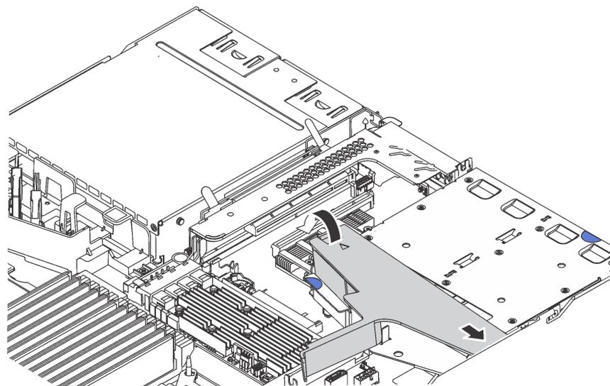
Рис. 97. Установка дефлектора
