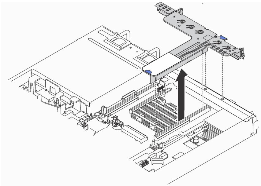
Рис. 76. Снятие блока платы-адаптера Riser
