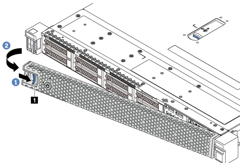
Рис. 57. Снятие защитной панели
