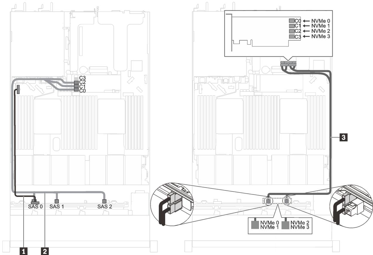
Рис. 38. Прокладка кабелей для моделей серверов с шестью 2,5-дюймовыми дисками SAS/SATA, четырьмя 2,5-дюймовыми дисками NVMe, одним адаптером 16i RAID и одним адаптером-переключателем NVMe 1610-4P в гнезде PCIe 2
