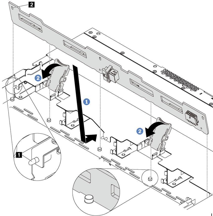
Рис. 88. Установка объединительной панели для четырех 3,5-дюймовых оперативно заменяемых дисков
