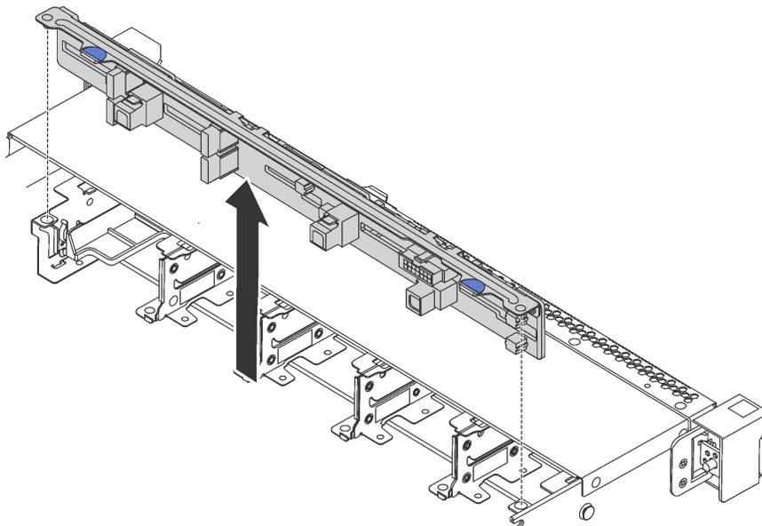
Рис. 91. Снятие объединительной панели для десяти 2,5-дюймовых оперативно заменяемых дисков
