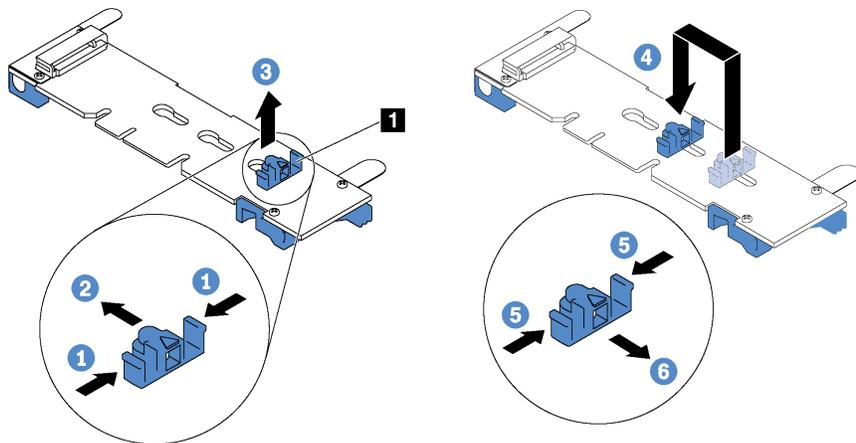
Рис. 116. Регулировка фиксатора M.2
