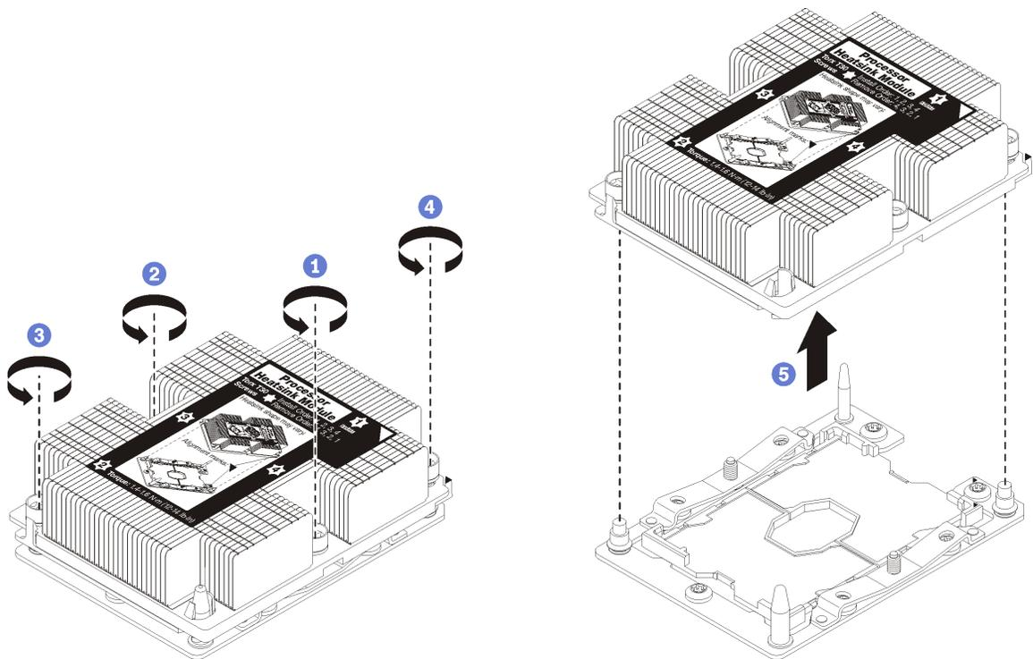
Рис. 144. Снятие модуля РНМ
