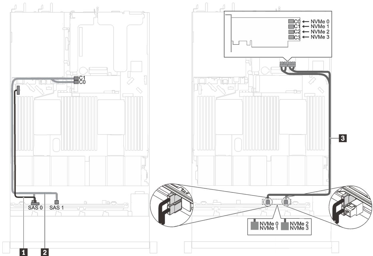
Рис. 37. Прокладка кабелей для моделей серверов с шестью 2,5-дюймовыми дисками SAS/SATA, четырьмя 2,5-дюймовыми дисками NVMe, одним адаптером 8i RAID и одним адаптером-переключателем NVMe 1610-4P в гнезде PCIe 2
