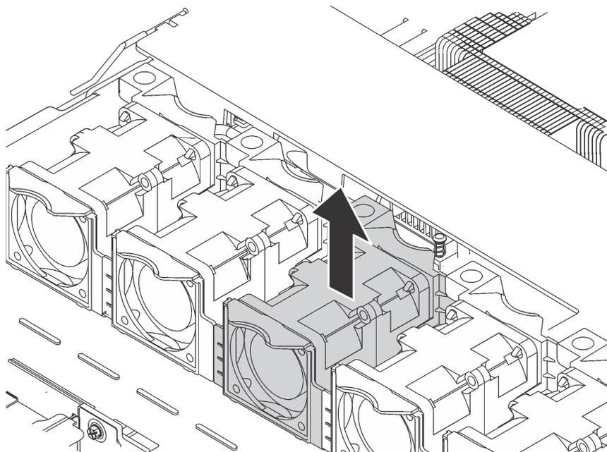
Рис. 61. Снятие вентилятора компьютера
