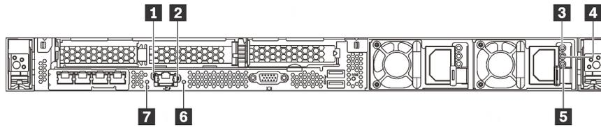
Рис. 17. Светодиодные индикаторы на задней панели
