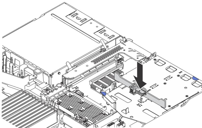
Рис. 95. Установка задней объединительной панели
