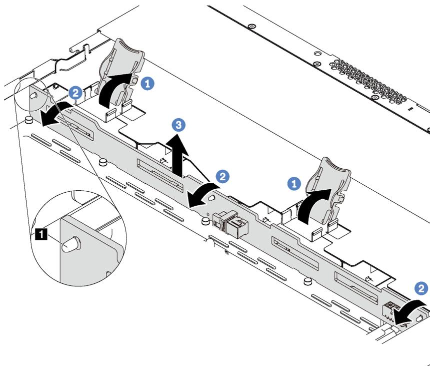
Рис. 87. Снятие объединительной панели для четырех 3,5-дюймовых оперативно заменяемых дисков
