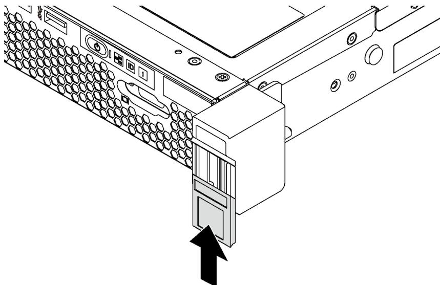
Рис. 55. Установка пластинки с идентификационной этикеткой
