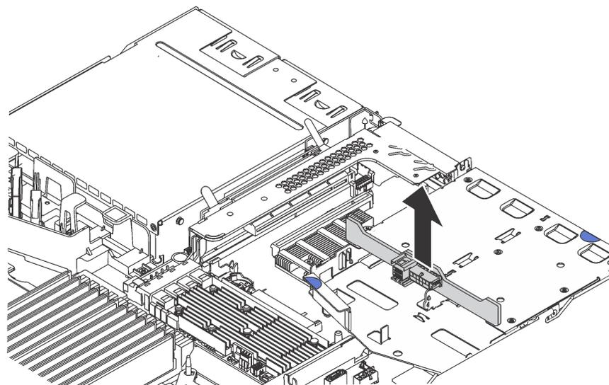
Рис. 94. Снятие задней объединительной панели
