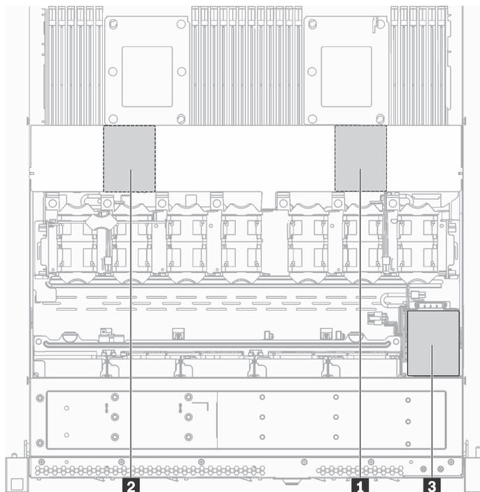
Рис. 126. Местоположение модуля суперконденсатора RAID
