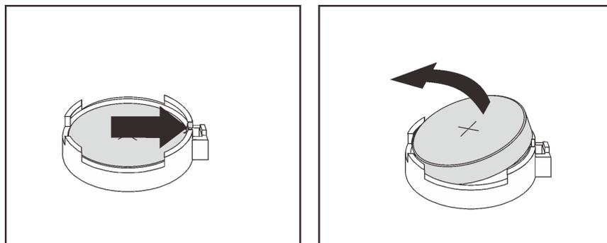
Рис. 98. Извлечение батарейки CMOS
