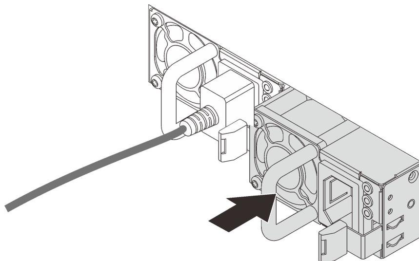
*Рис. 142. Установка оперативно заменяемого блока питания*
