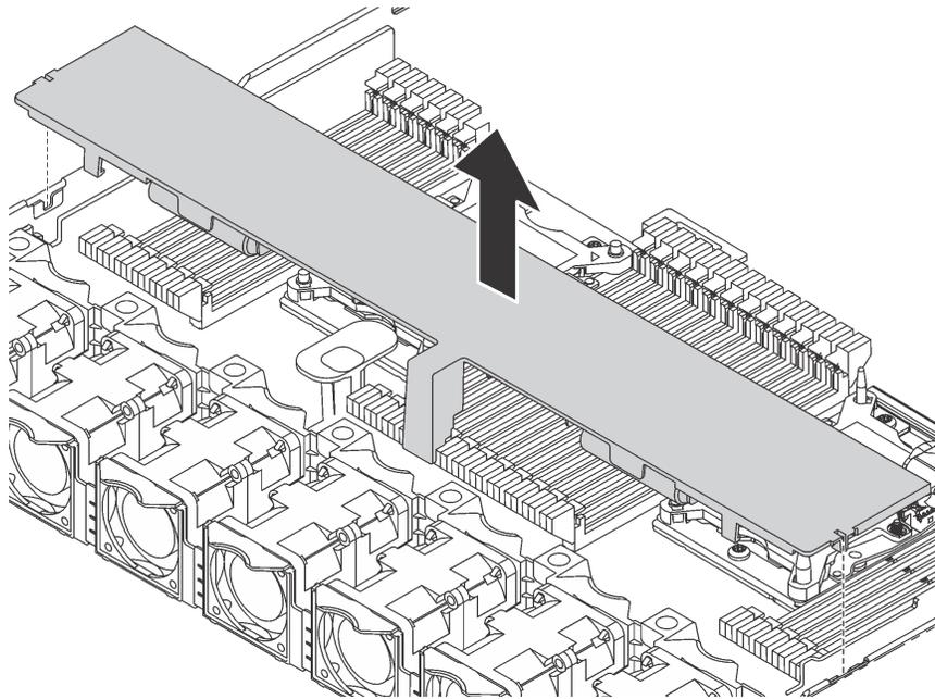
Рис. 48. Снятие дефлектора
