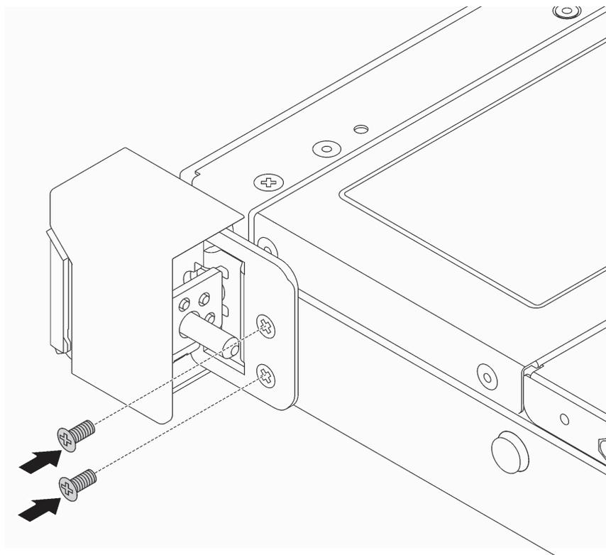
Рис. 54. Установка винтов защелки стойки
