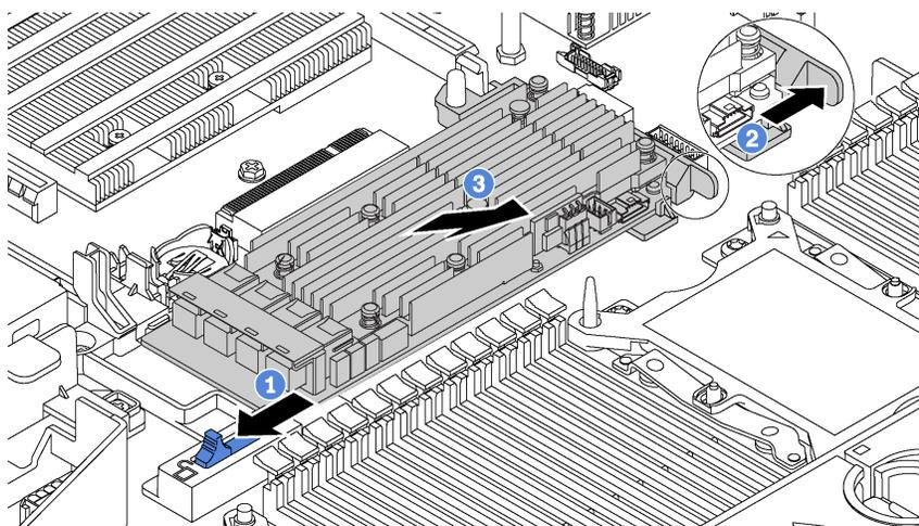
Рис. 107. Снятие адаптера RAID
