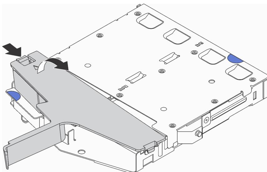
Рис. 103. Снятие дефлектора
