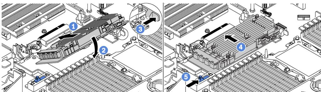
Рис. 108. Установка адаптера RAID
