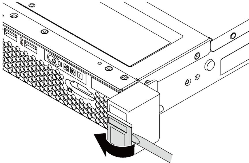
Рис. 50. Снятие пластинки с идентификационной этикеткой
