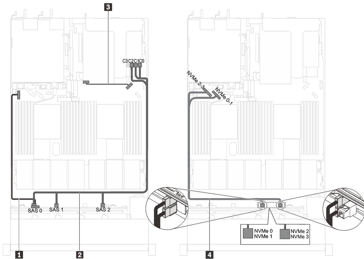
Рис. 36. Прокладка кабелей для моделей серверов с шестью 2,5-дюймовыми дисками SAS/SATA, четырьмя 2,5-дюймовыми дисками SAS/SATA/NVMe и графическим процессором максимальной высоты, половинной длины
