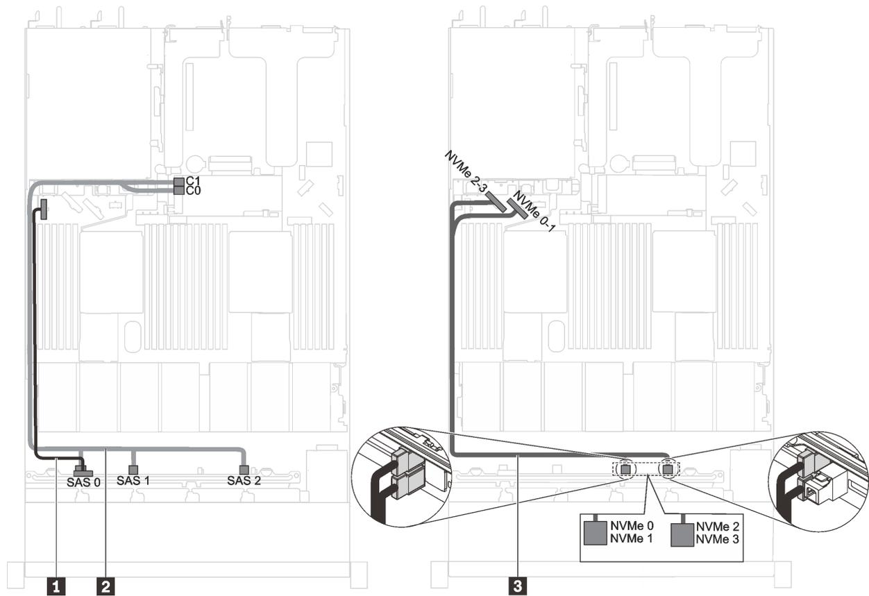
Рис. 35. Прокладка кабелей для моделей серверов с процессором Intel Xeon 6154, 6254 и 6240Y, четырем 2,5-дюймовыми дисками SAS/SATA/NVMe и одним адаптером RAID 8i
