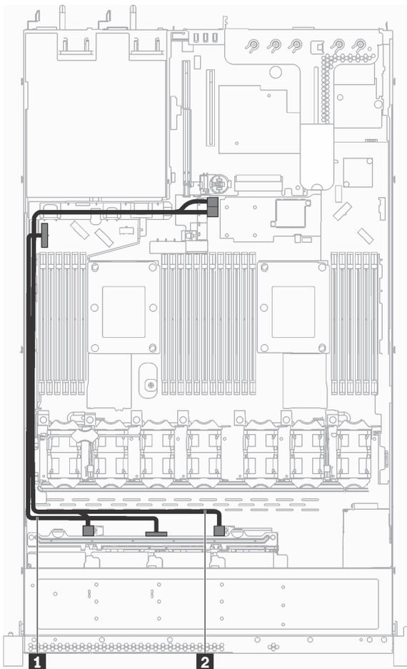
Рис. 29. Прокладка кабелей для моделей серверов с восемью 2,5-дюймовыми дисками SAS/SATA и одним адаптером 8i RAID
