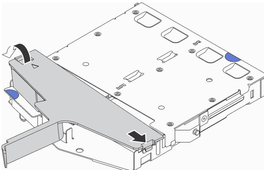
Рис. 105. Установка дефлектора
