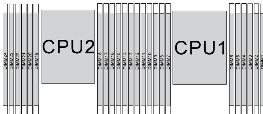
Рис. 65. гнезда модулей памяти на материнской плате
