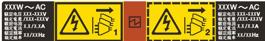
Рис. 136. Этикетка оперативно заменяемого блока питания на крышке
