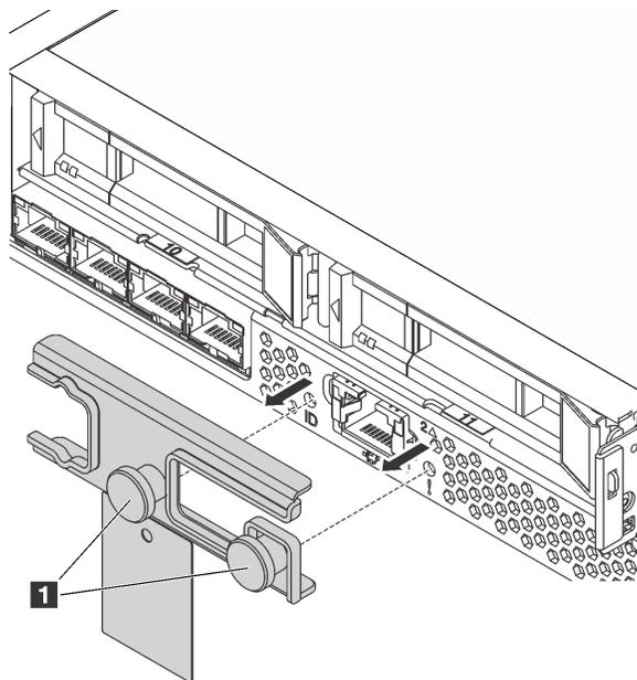
Рис. 15. Снятие транспортировочной скобы
