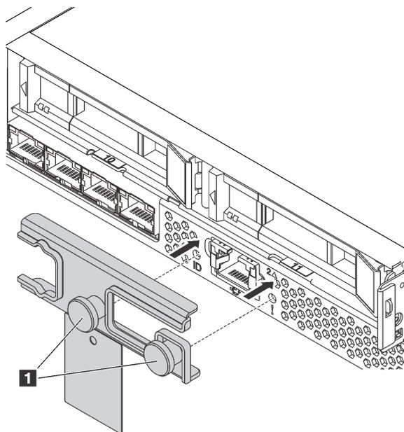
Рис. 16. Установка транспортировочной скобы
