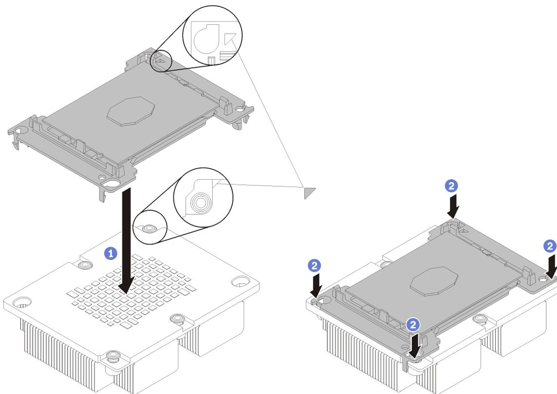
Рис. 152. Сборка модуля процессора с радиатором (PHM) вне транспортного лотка
