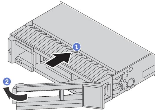
Рис. 70. Установка оперативно заменяемого диска
