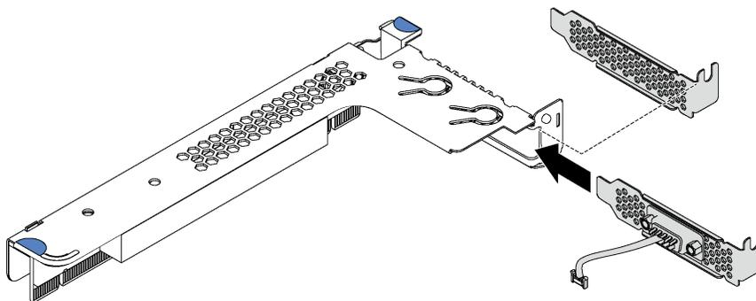
Рис. 112. Установка модуля последовательного порта
