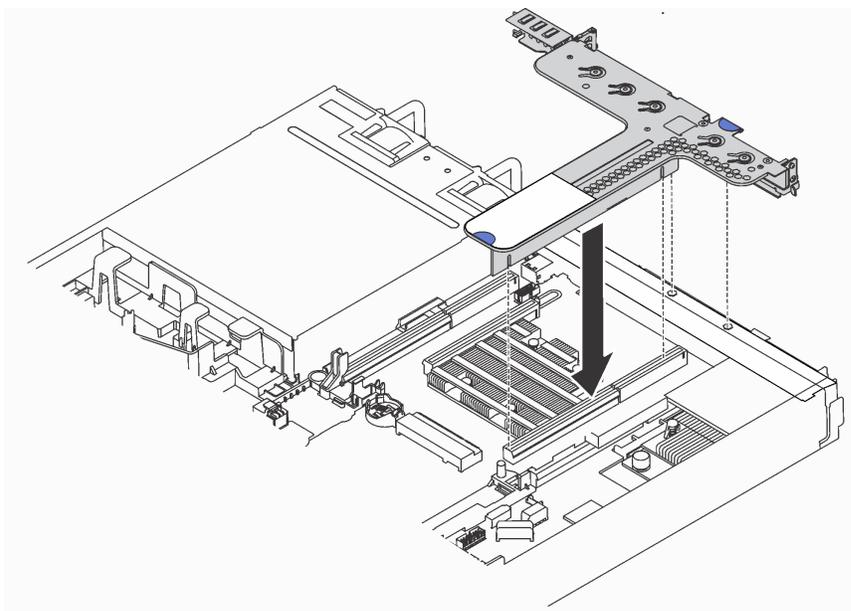
Рис. 79. Установка блока платы-адаптера Riser
