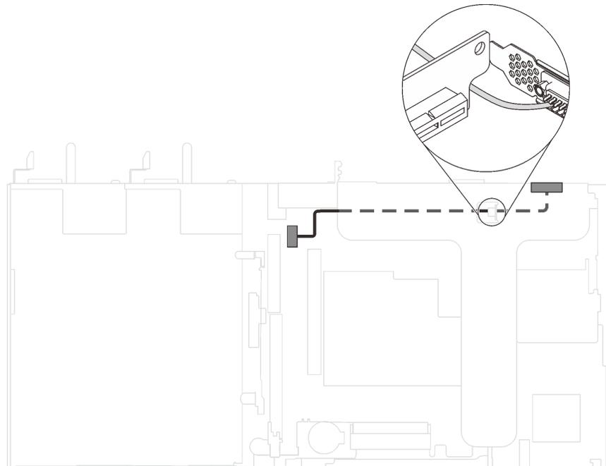
Рис. 113. Прокладка кабелей для модуля последовательного порта, установленного в гнезде PCIe 1
