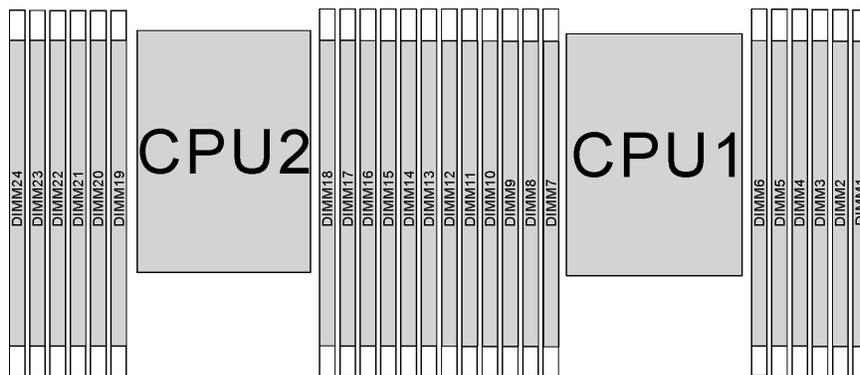
Рис. 64. гнезда модулей памяти на материнской плате
