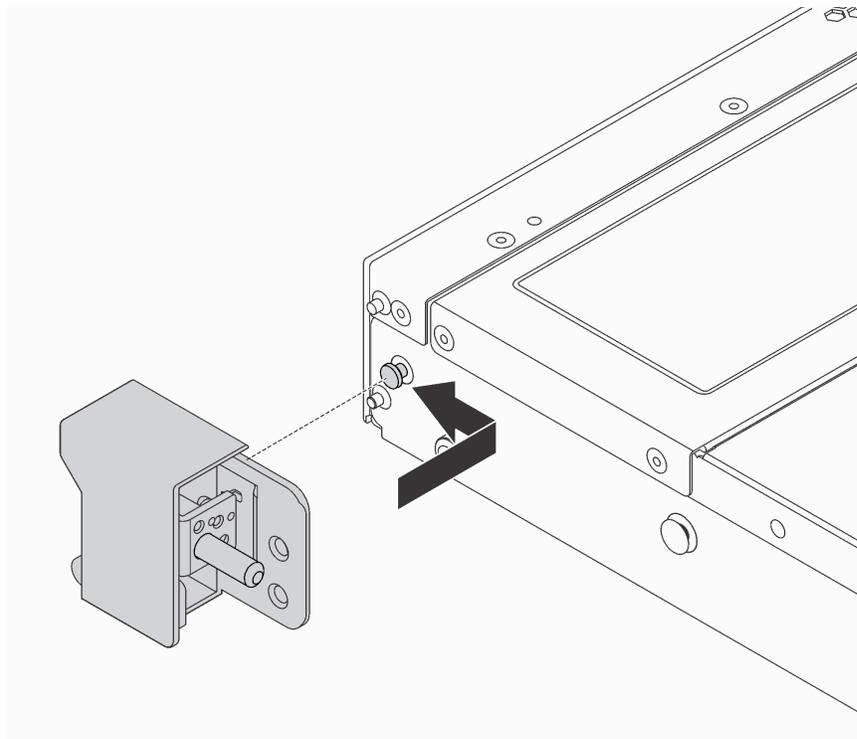
Рис. 53. Установка защелки стойки
