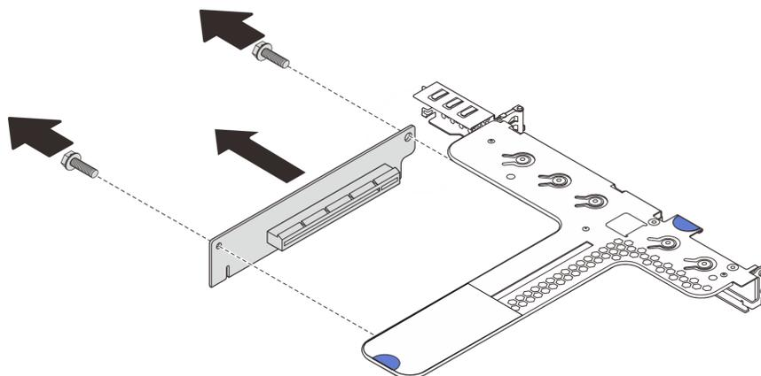
Рис. 77. Снятие платы-адаптера Riser
