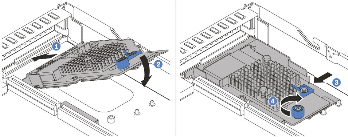
Рис. 72. Установка адаптера LOM
