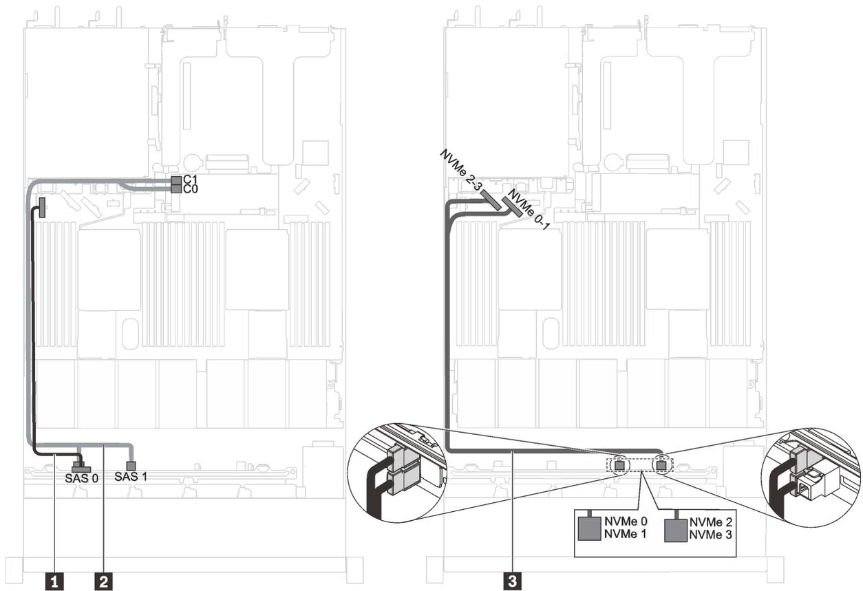
Рис. 34. Прокладка кабелей для моделей серверов с шестью 2,5-дюймовыми дисками SAS/SATA, четырьмя 2,5-дюймовыми дисками NVMe и одним адаптером RAID 8i
