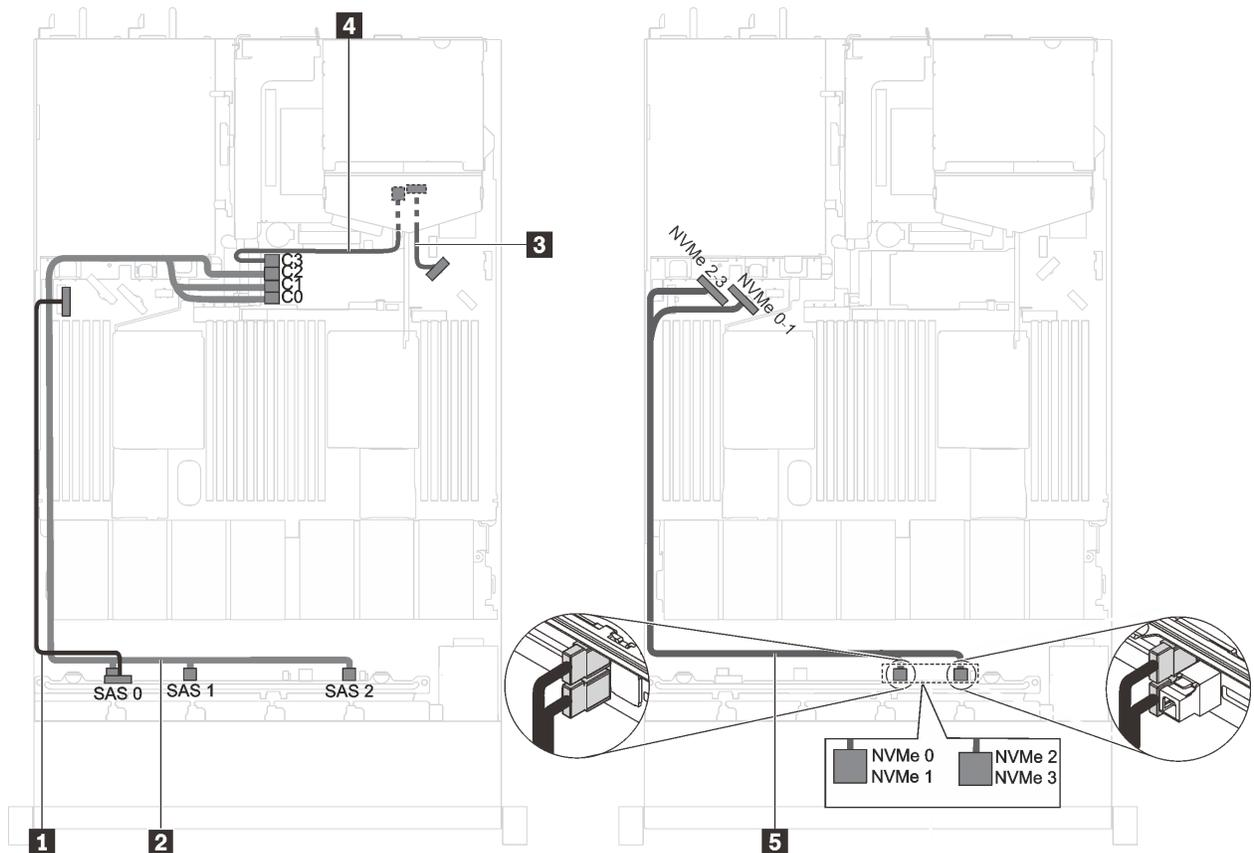
Рис. 33. Прокладка кабелей для моделей серверов с шестью 2,5-дюймовыми дисками SAS/SATA, четырьмя 2,5-дюймовыми дисками SAS/SATA/NVMe, одним адаптером RAID 16i и задним блоком дисков
