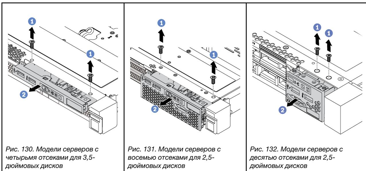
Шаг 1. Открутите винты, фиксирующие передний блок ввода-вывода.
