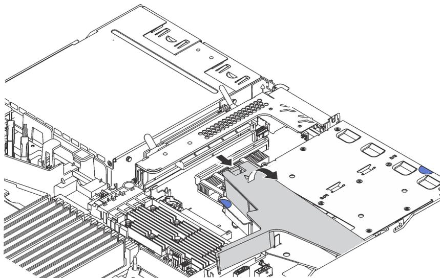
Рис. 93. Снятие дефлектора
