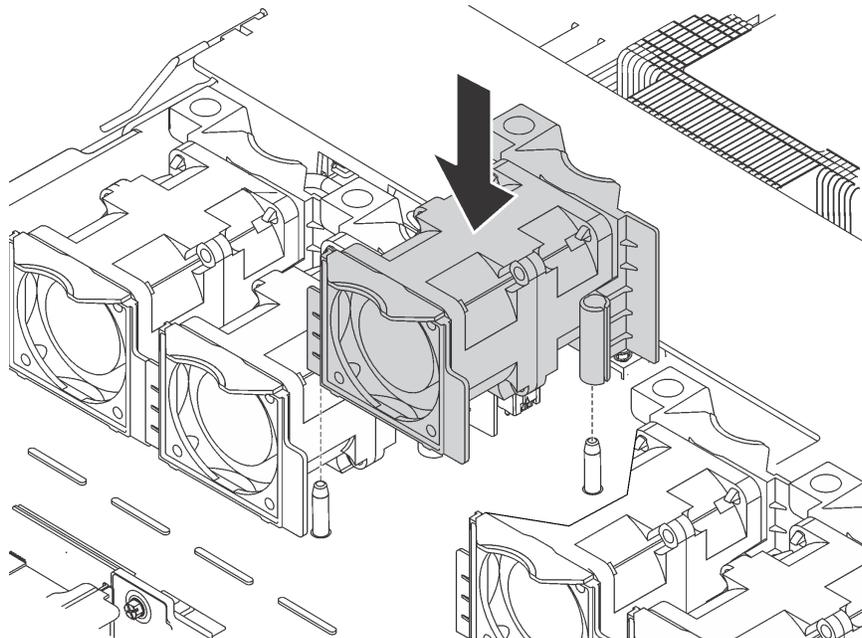
Рис. 62. Установка вентилятора компьютера
