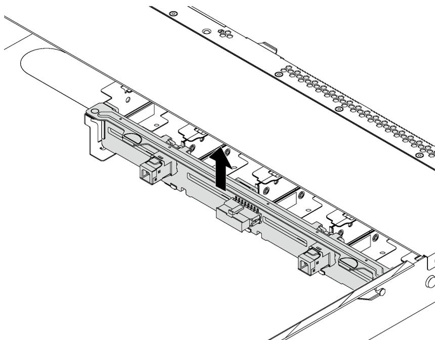
Рис. 89. Снятие объединительной панели для восьми 2,5-дюймовых оперативно заменяемых дисков
