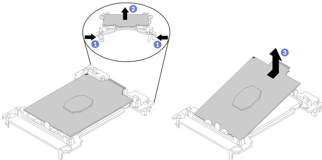
Рис. 147. Снятие фиксатора процессора IFT
