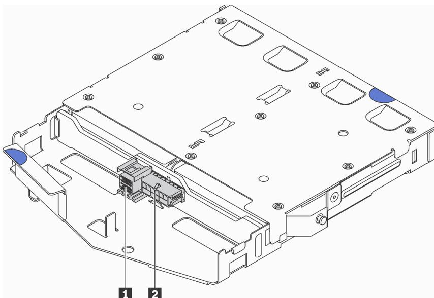
Рис. 104. Разъемы задней объединительной панели
