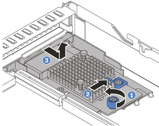
Рис. 71. Снятие адаптера LOM
