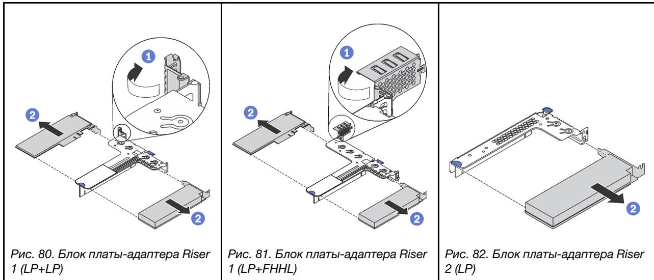
Шаг 1. (Для блока платы-адаптера Riser 2 пропустите этот шаг.) Поверните защелку на крепежной скобе платы-адаптера Riser в открытое положение.
