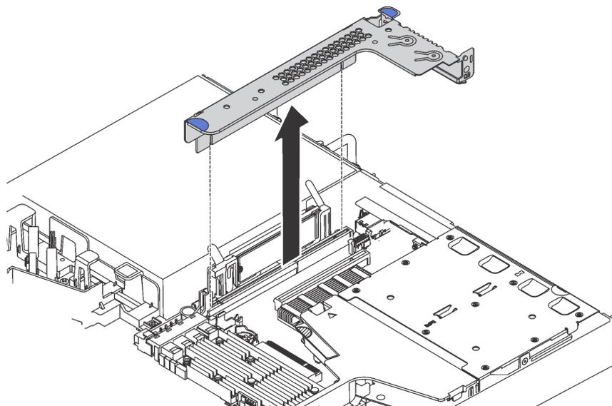
Рис. 111. Снятие блока платы-адаптера Riser
