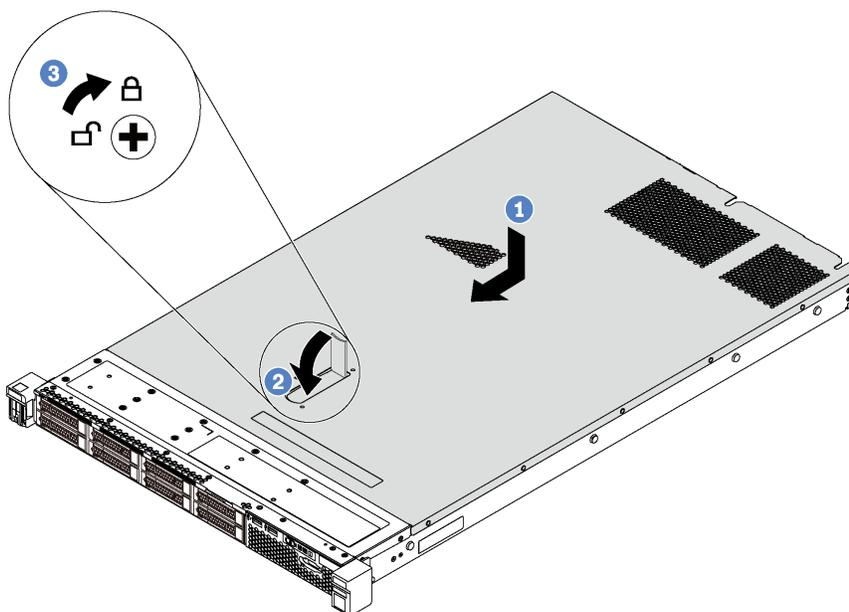
Рис. 47. Установка верхнего кожуха
