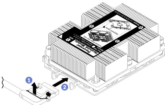
Рис. 154. Подключение разъема IFT
