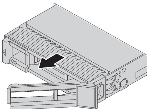
Рис. 68. Извлечение оперативно заменяемого диска
