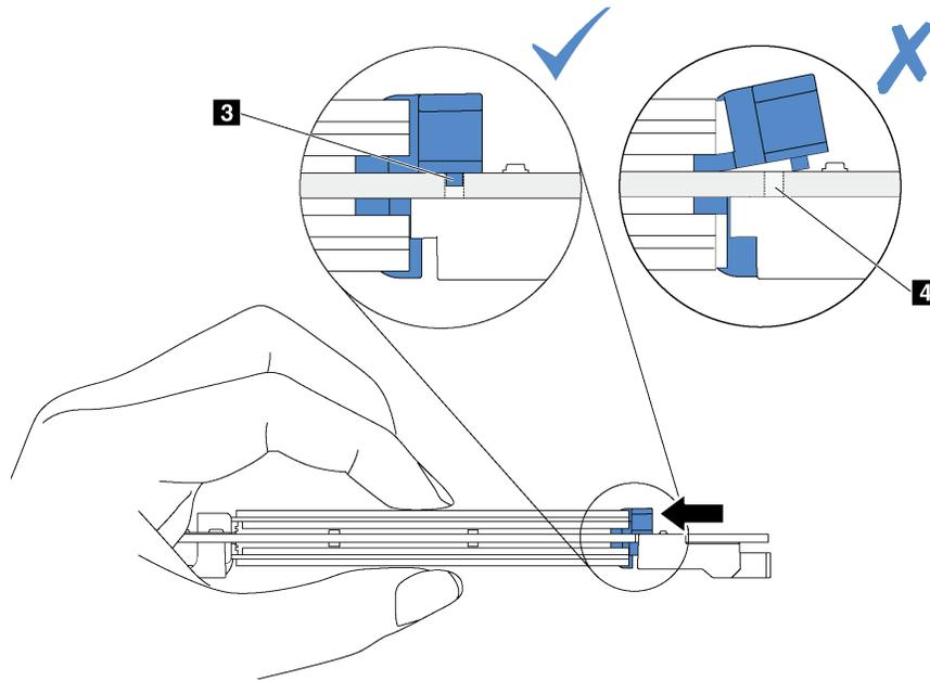
Рис. 119. Инструкция по перемещению фиксатора
