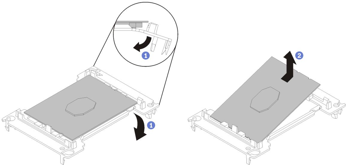
Рис. 146. Снятие фиксатора процессора, не являющегося процессором IFT
