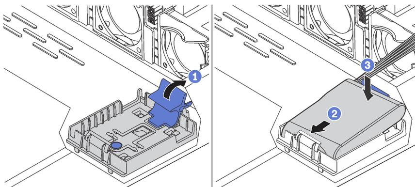
Рис. 129. Установка модуля суперконденсатора RAID в раму
