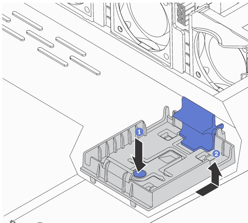
Рис. 125. Снятие держателя модуля суперконденсатора RAID
