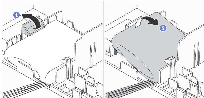
Рис. 121. Снятие модуля суперконденсатора RAID в нижней части дефлектора
