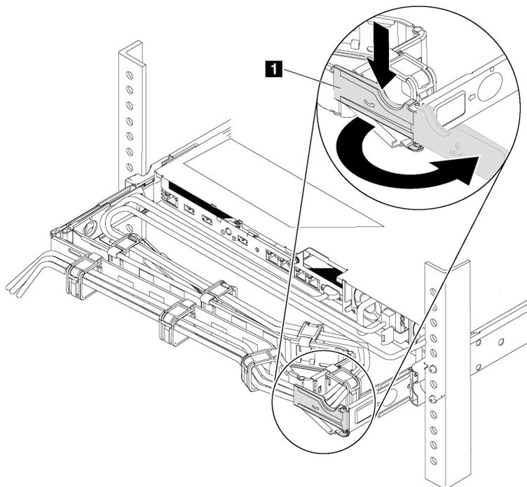
Рис. 140. Регулировка SMA
