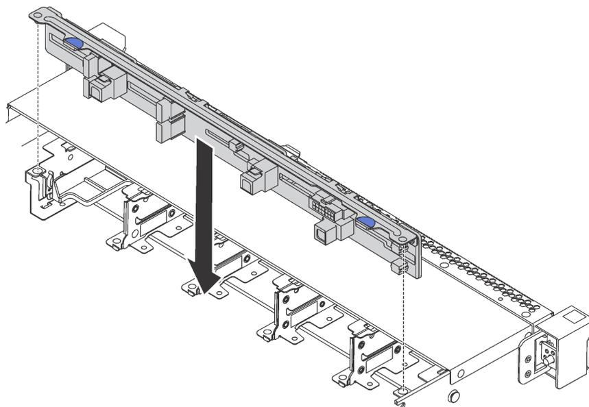
Рис. 92. Установка объединительной панели для десяти 2,5-дюймовых оперативно заменяемых дисков
