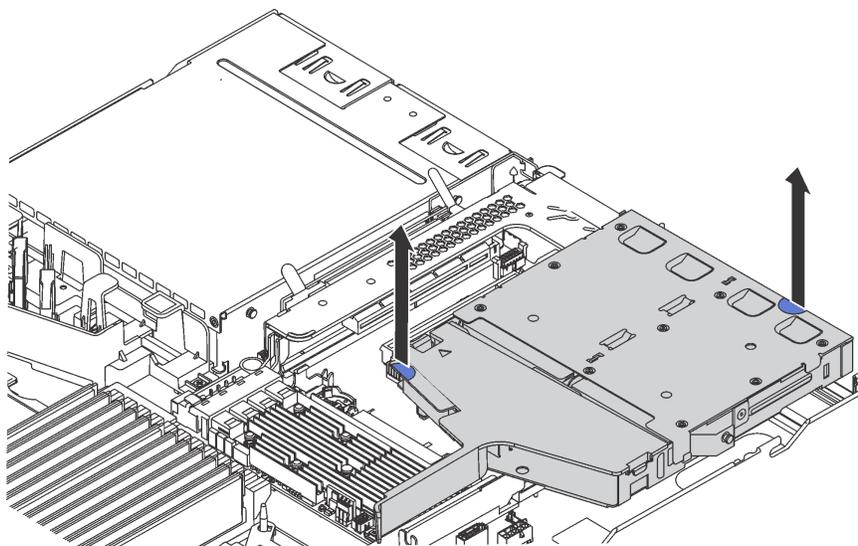
Рис. 102. Снятие заднего блока оперативно заменяемых дисков
