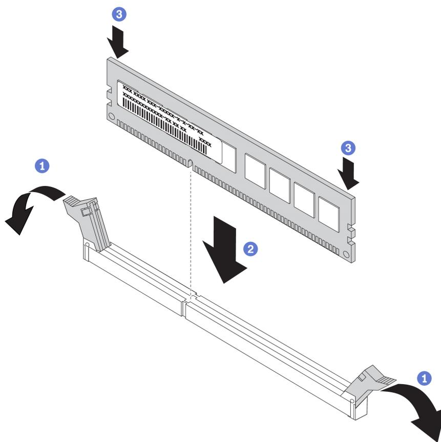
Рис. 66. Установка модуля памяти
