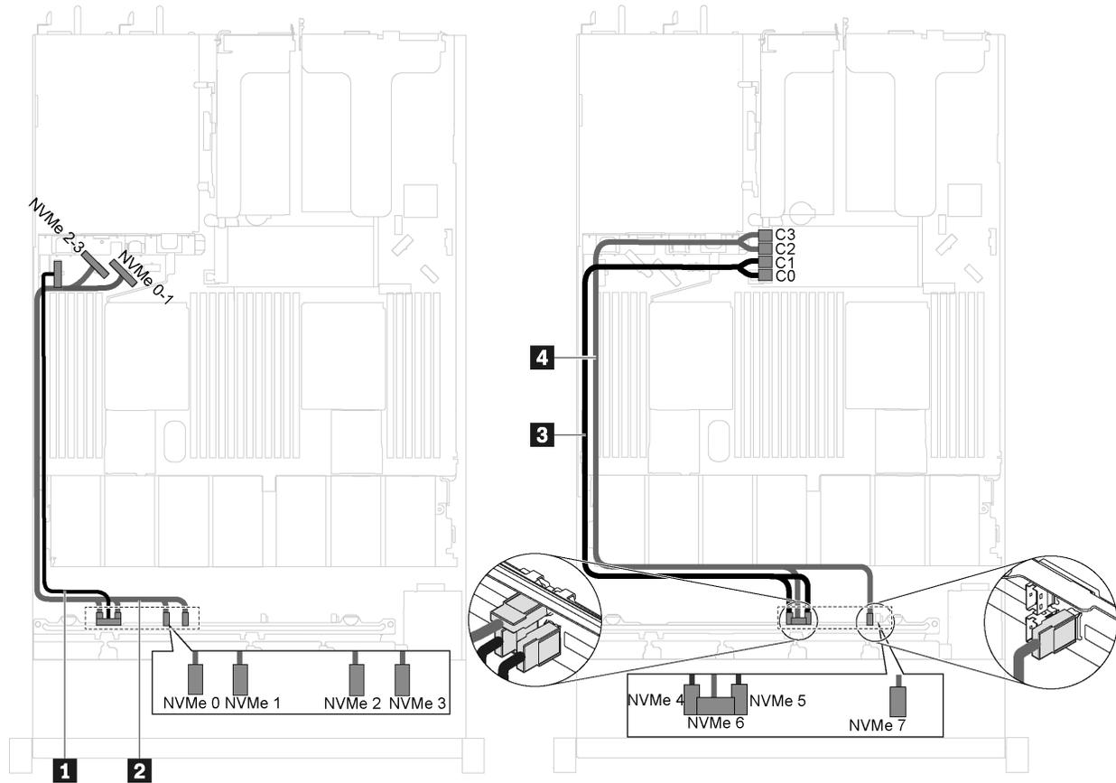
Рис. 43. Прокладка кабелей для моделей серверов с восемью 2,5-дюймовыми дисками NVMe и одним адаптером-переключателем NVMe 810-4P в гнезде адаптера RAID
