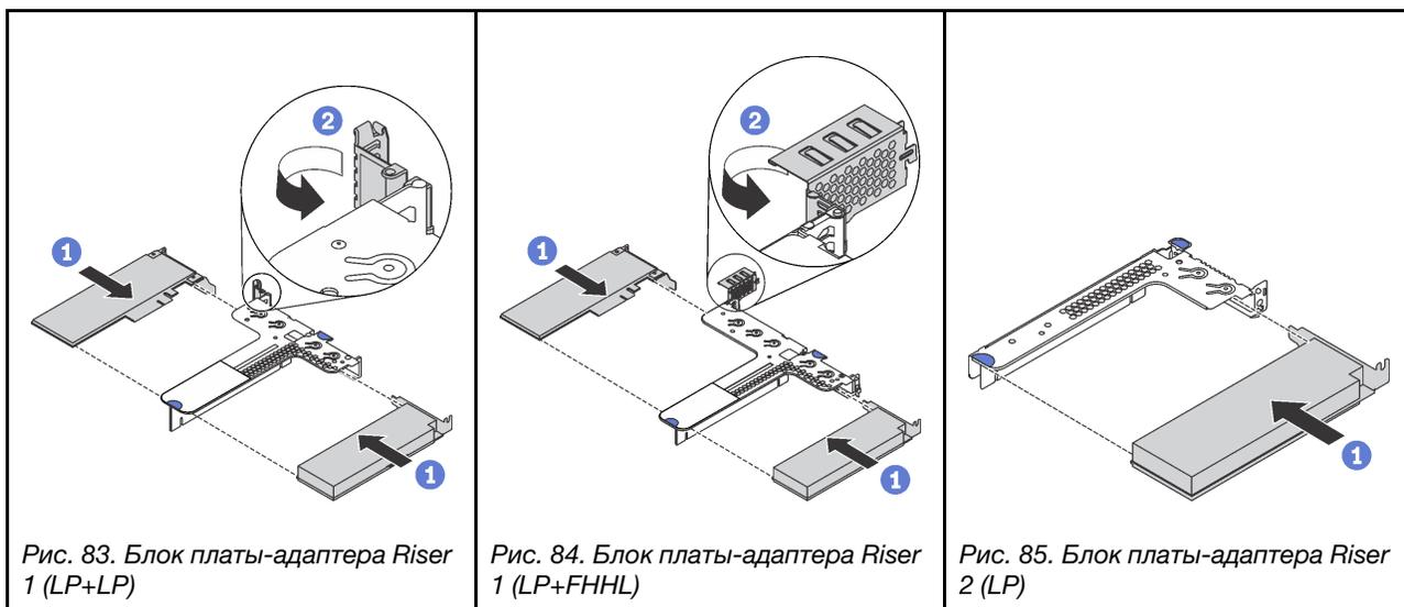
Шаг 1. Совместите адаптер PCIe с гнездом PCIe на плате-адаптере Riser. Затем осторожно нажмите на адаптер PCIe, чтобы она плотно вошла в гнездо, а ее скоба зафиксировалась.
