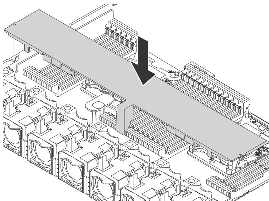
Рис. 49. Установка дефлектора
