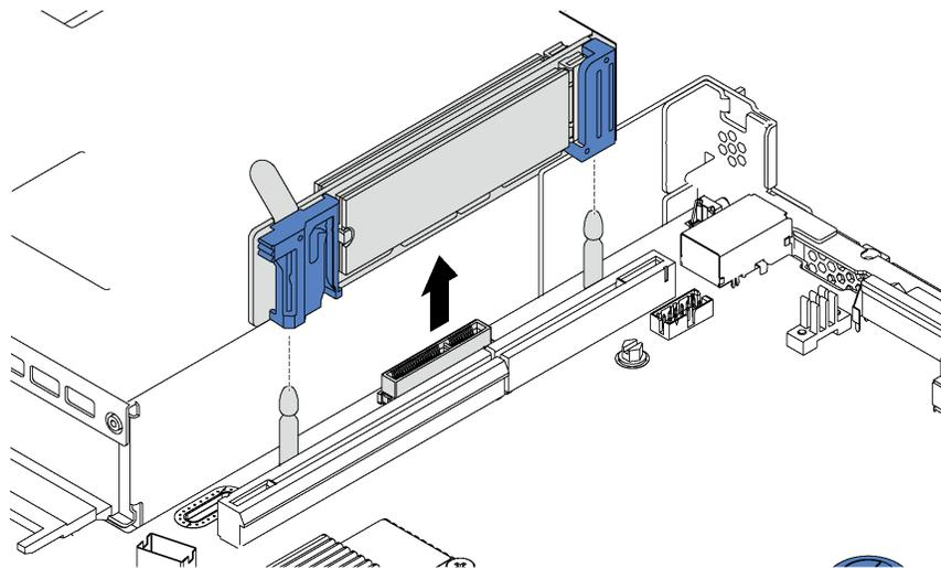
Рис. 114. Снятие объединительной панели M.2
