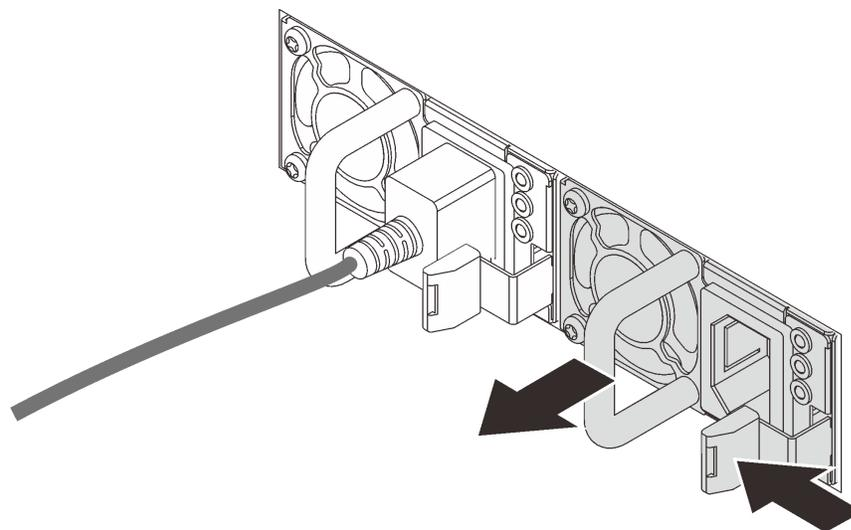
Рис. 138. Снятие оперативно заменяемого блока питания
