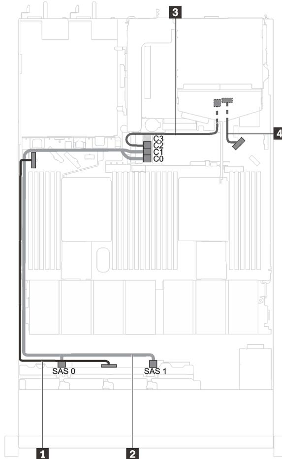
Рис. 30. Прокладка кабелей для моделей серверов с восемью 2,5-дюймовыми дисками SAS/SATA, одним адаптером RAID 16i и задним блоком дисков
