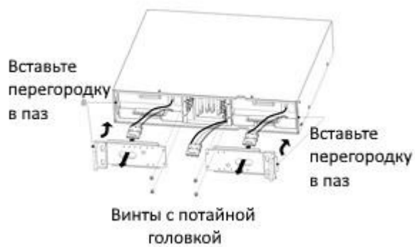
Рисунок 7. Установка новых аккумуляторных батарей
