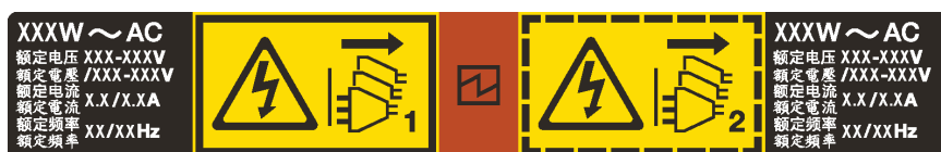
Рис. 100. Этикетка оперативно заменяемого блока питания на крышке
