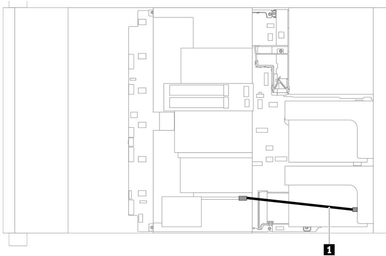
**Примечание:** Для подключения каждого модуля суперконденсатора RAID предоставляется удлинитель. Подключите кабель суперконденсатора к разъему суперконденсатора на соответствующем адаптере RAID, как показано на рисунке.
