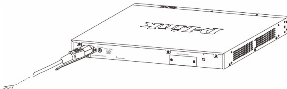
Рисунок 9 — Подключение кабеля питания к коммутатору
