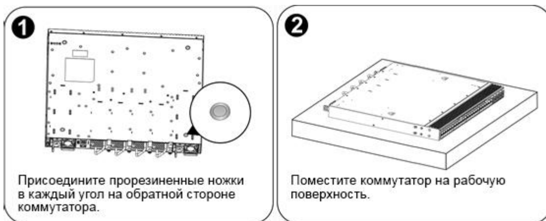
Рисунок 3-3 Установка коммутатора на рабочее место
