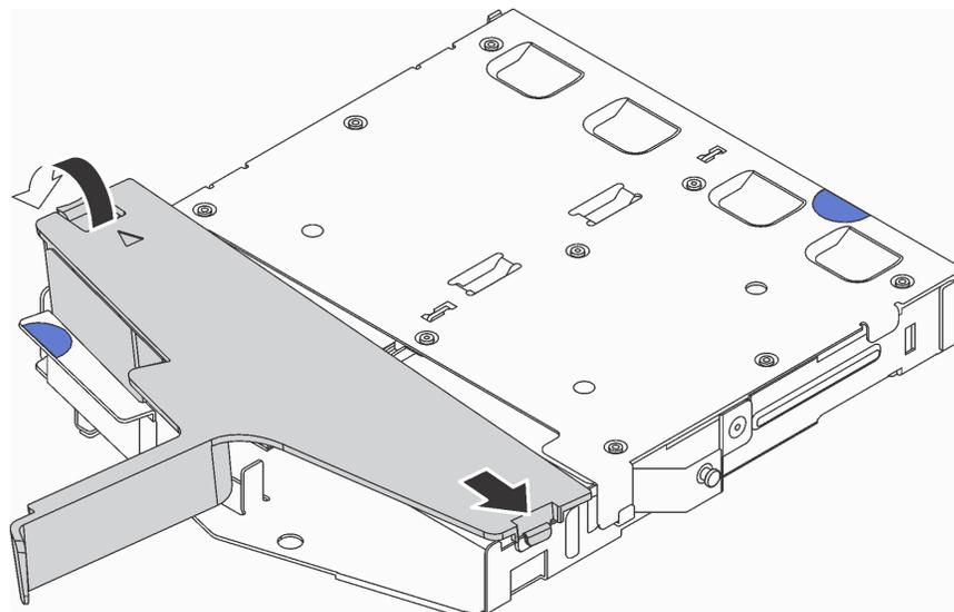
Рис. 107. Установка дефлектора
