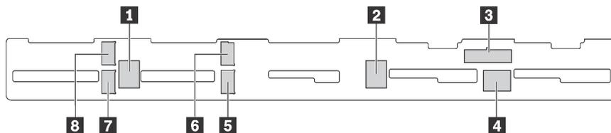
Рис. 32. Разъемы на объединительной панели для десяти 2,5-дюймовых дисков SAS/SATA/NVMe
