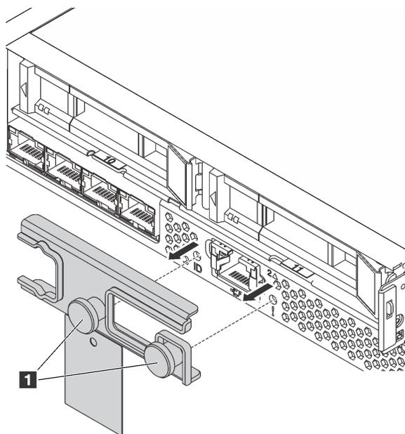
Рис. 15. Снятие транспортировочной скобы
