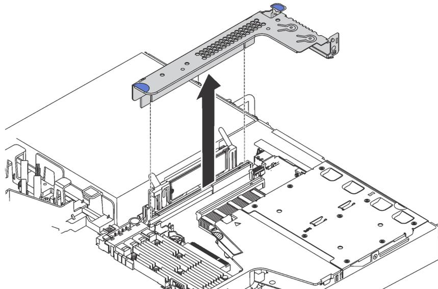
Рис. 111. Снятие блока платы-адаптера Riser
