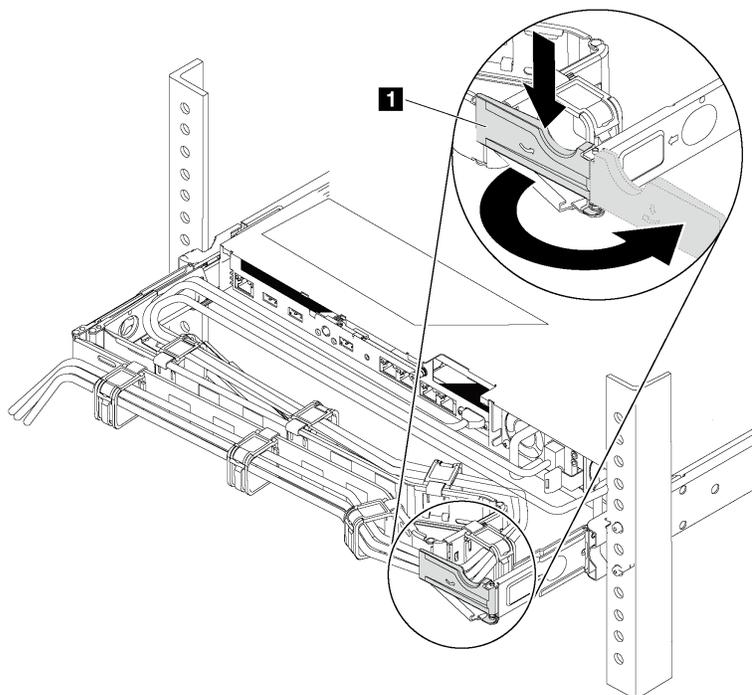
Рис. 142. Регулировка СМА
