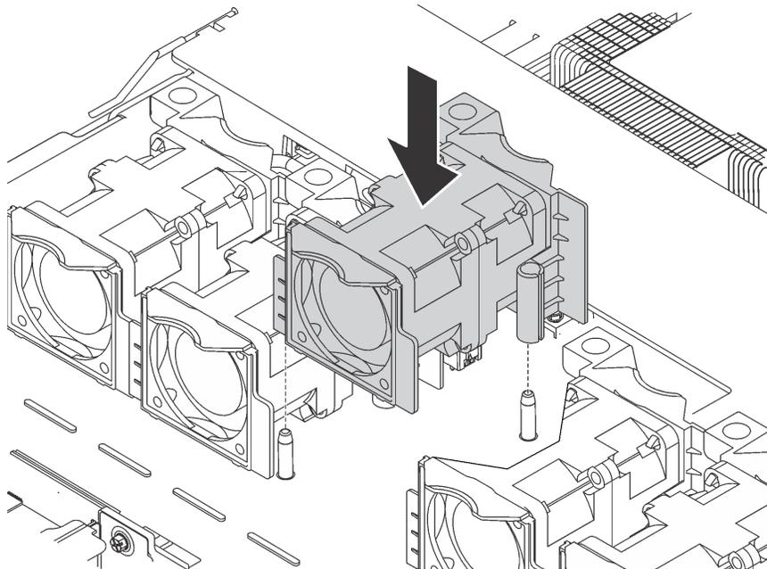
Рис. 64. Установка вентилятора компьютера
