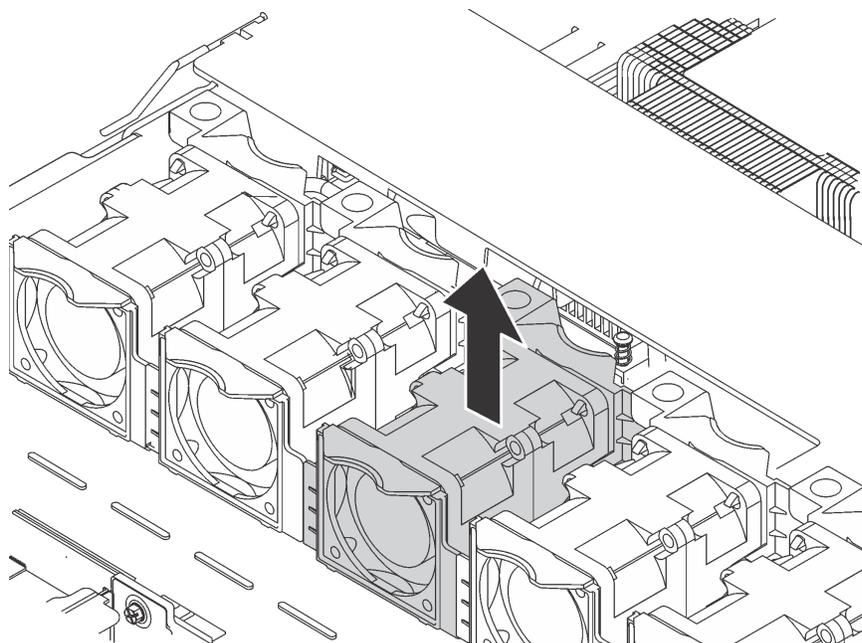
Рис. 63. Снятие вентилятора компьютера
