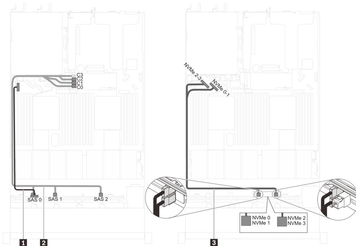
Рис. 37. Прокладка кабелей для моделей серверов с процессором Intel Xeon 6154, 6254 и 6240Y, четырьмя 2,5-дюймовыми дисками SAS/SATA/NVMe и одним адаптером HBA/RAID 16i
