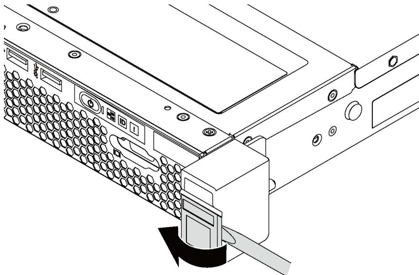
Рис. 52. Снятие пластинки с идентификационной этикеткой
