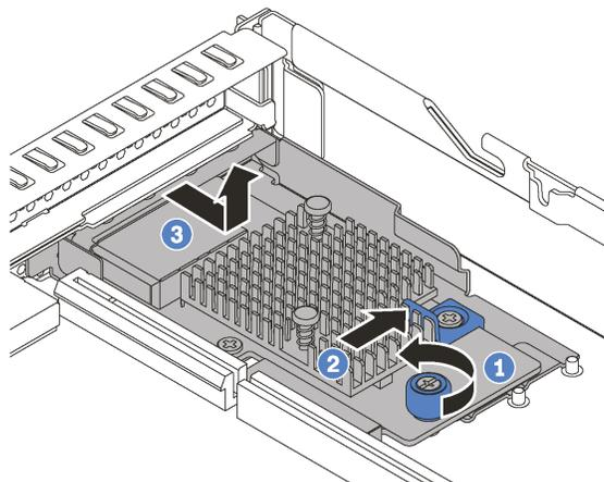
Рис. 73. Снятие адаптера LOM
