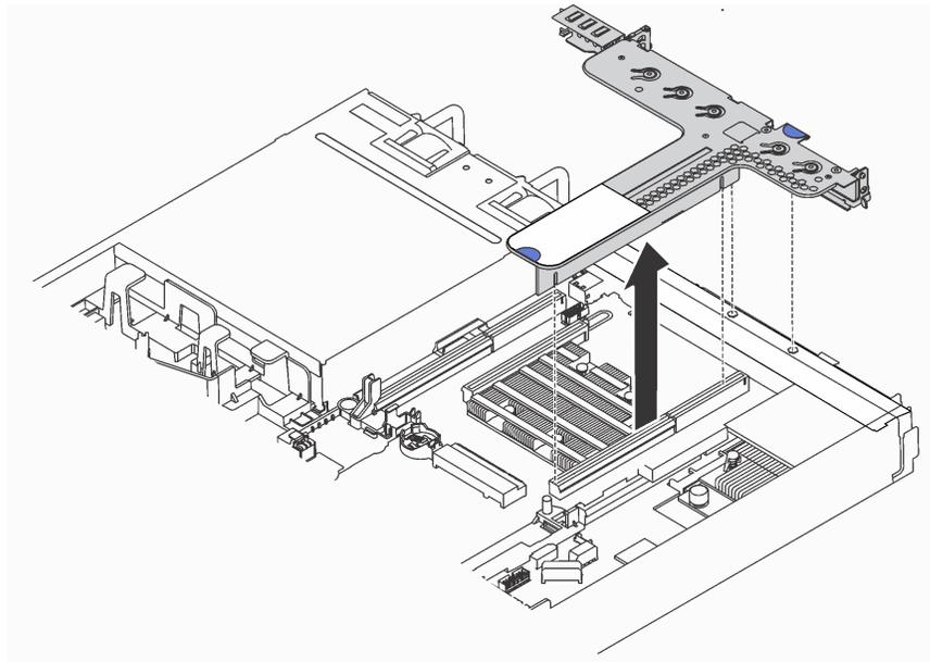
Рис. 78. Снятие блока платы-адаптера Riser
