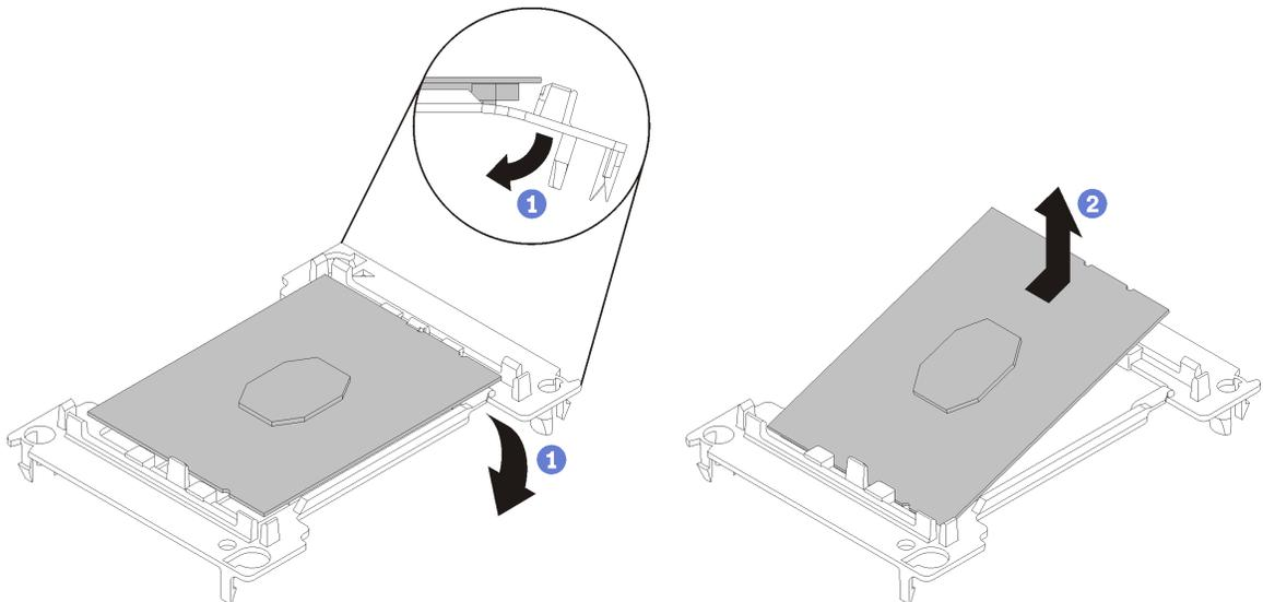
Рис. 147. Снятие фиксатора процессора
