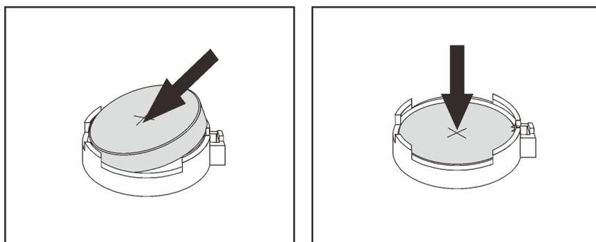
Рис. 101. Установка батарейки CMOS
