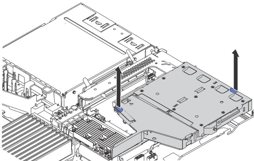
Рис. 104. Снятие заднего блока оперативно заменяемых дисков
