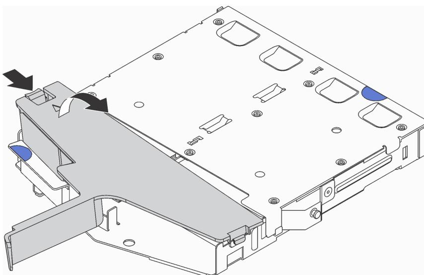
Рис. 105. Снятие дефлектора
