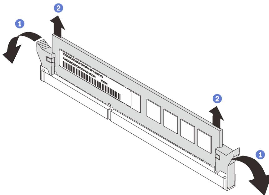
Рис. 65. Снятие модуля памяти
