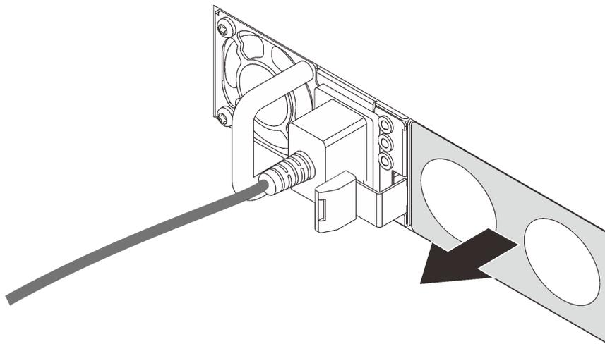
Рис. 143. Снятие заглушки оперативно заменяемого блока питания
