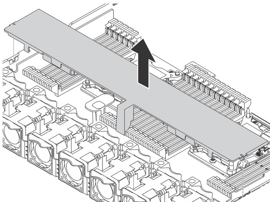
Рис. 50. Снятие дефлектора
