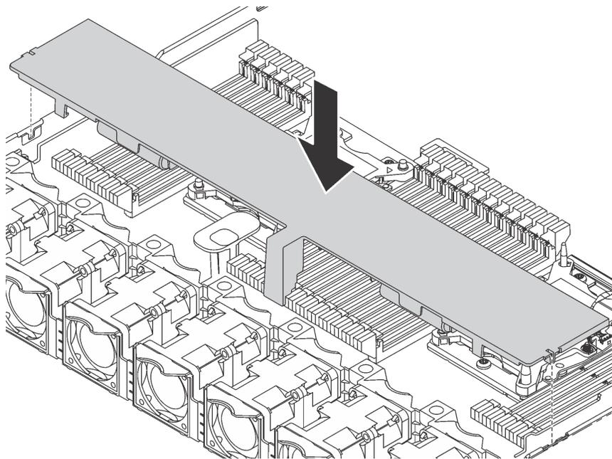
Рис. 51. Установка дефлектора
