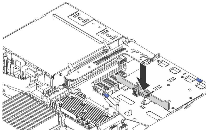
Рис. 97. Установка задней объединительной панели
