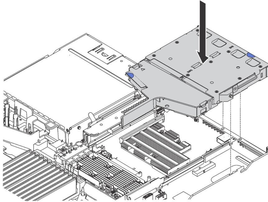
Рис. 108. Установка заднего блока оперативно заменяемых дисков
