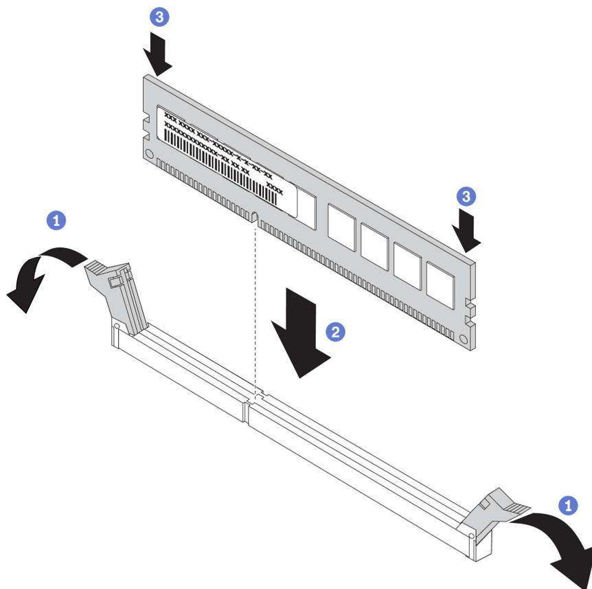
Рис. 68. Установка модуля памяти
