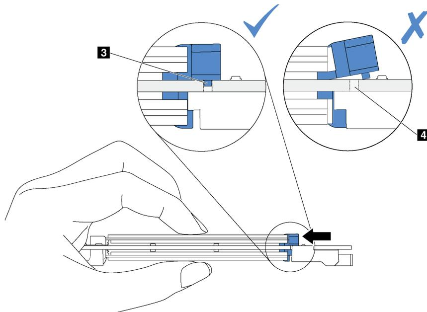
Рис. 121. Инструкция по перемещению фиксатора
