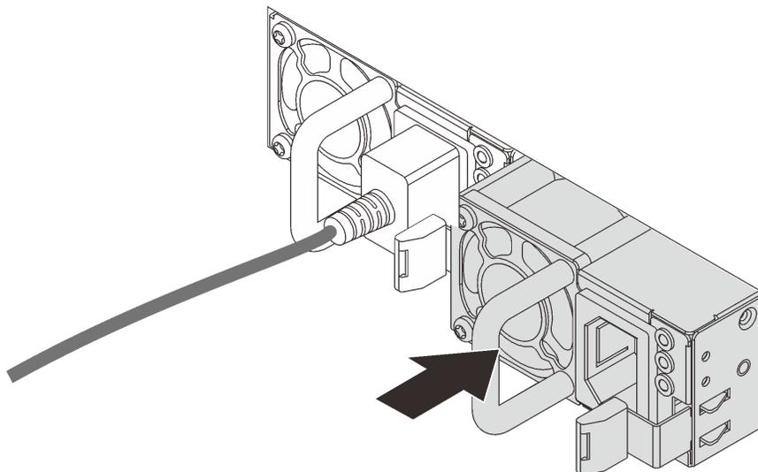
Рис. 144. Установка оперативно заменяемого блока питания
