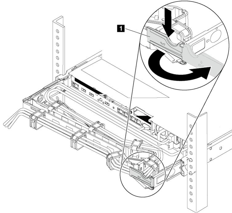
Рис. 139. Регулировка СМА
