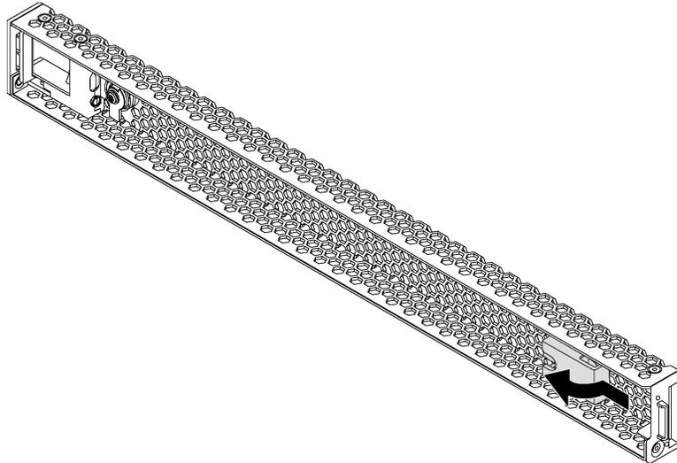
Рис. 60. Снятие ключа
