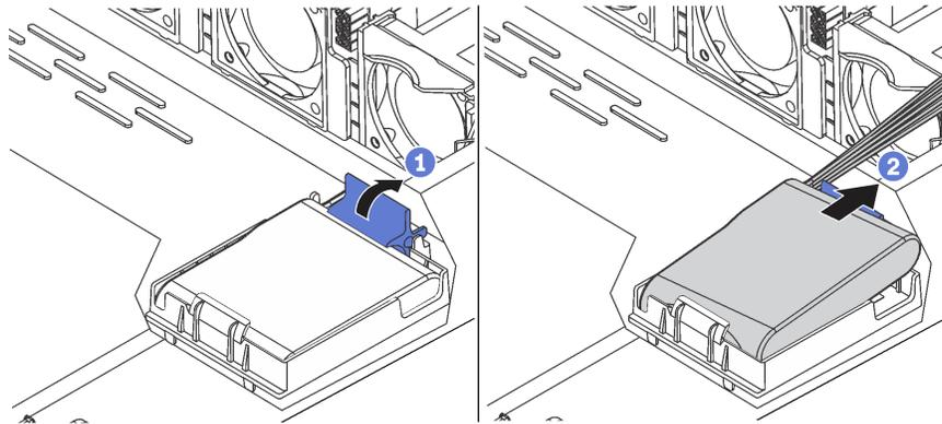
Рис. 126. Снятие модуля суперконденсатора RAID с рамы
