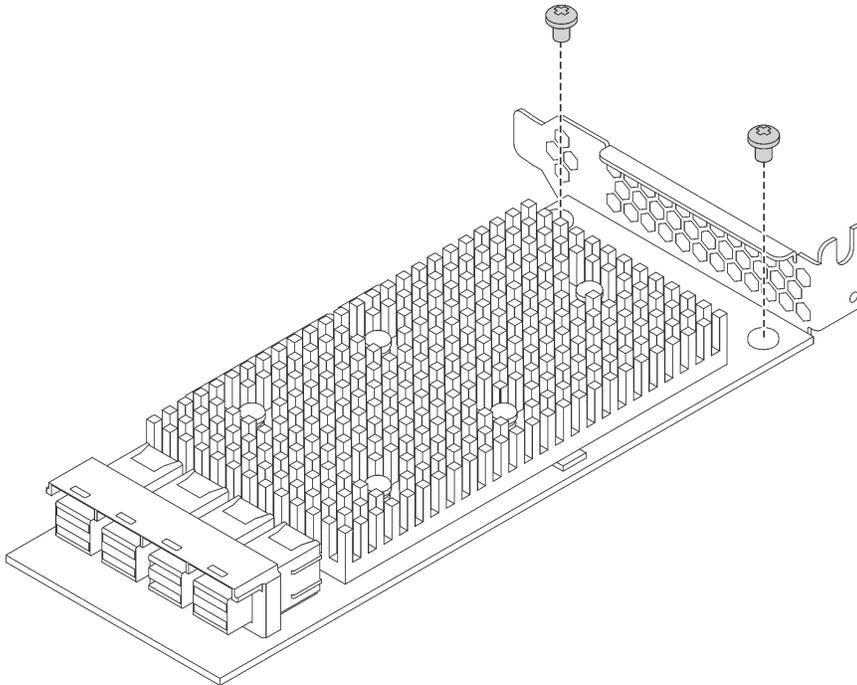
Рис. 88. Установка низкопрофильной скобы на адаптере RAID
