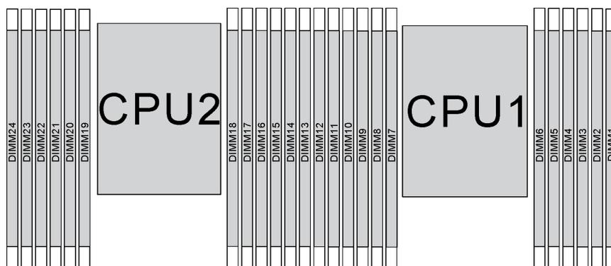
Рис. 67. Гнезда модулей памяти на материнской плате
