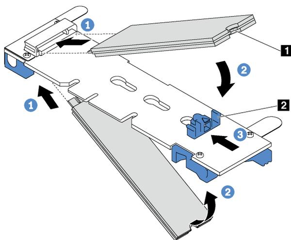
Рис. 120. Установка диска M.2
