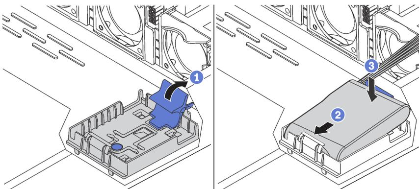
Рис. 131. Установка модуля суперконденсатора RAID в раму
