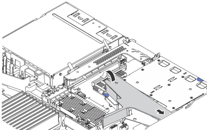
Рис. 99. Установка дефлектора
