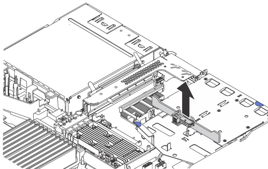
Рис. 96. Снятие задней объединительной панели
