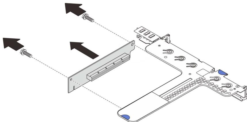
Рис. 79. Снятие платы-адаптера Riser
