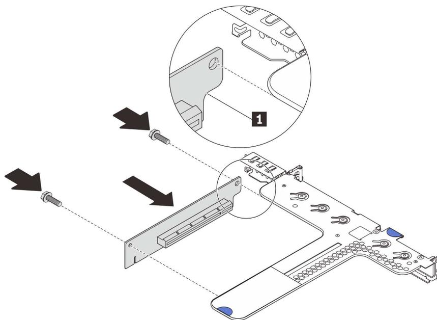
Рис. 80. Установка платы-адаптера Riser
