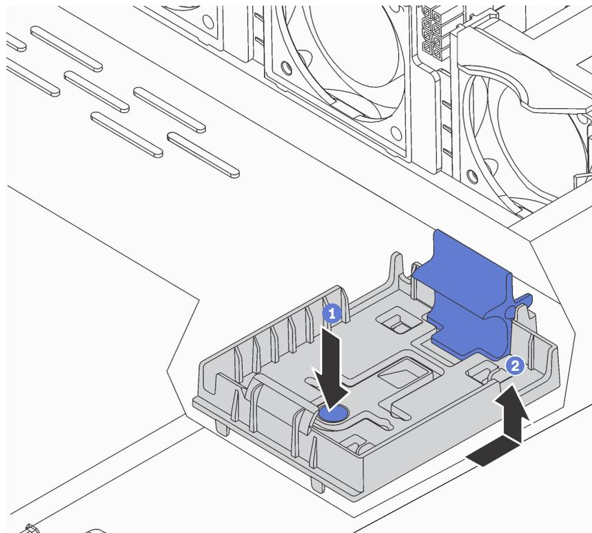
Рис. 127. Снятие держателя модуля суперконденсатора RAID
