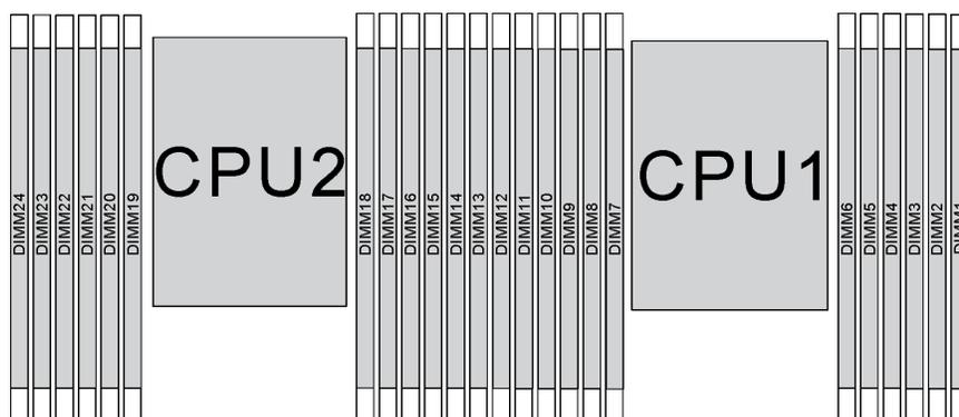
Рис. 66. Гнезда модулей памяти на материнской плате
