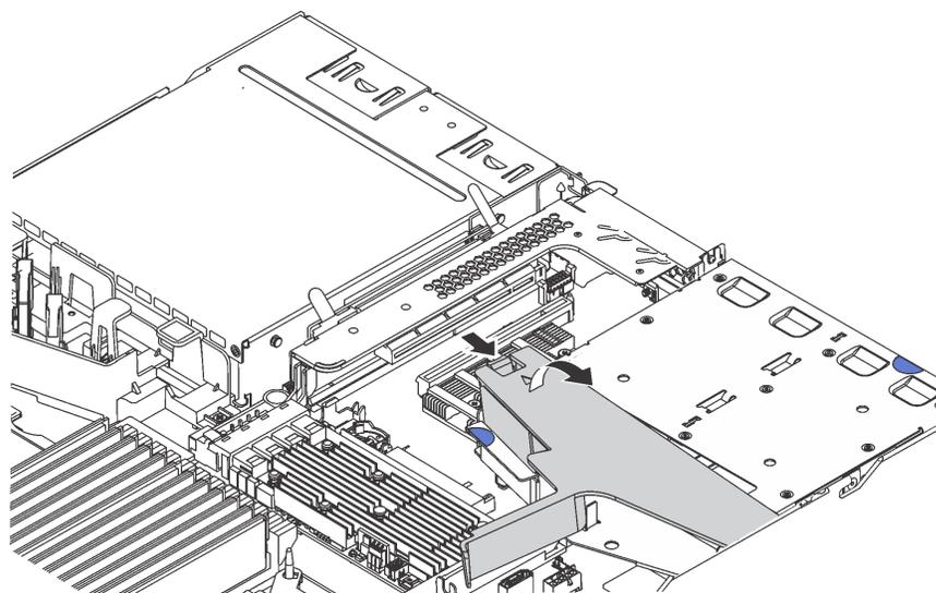
Рис. 95. Снятие дефлектора
