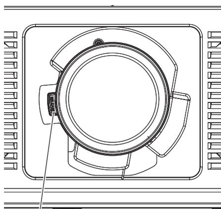
(i) Кнопка отсоединения объектива
