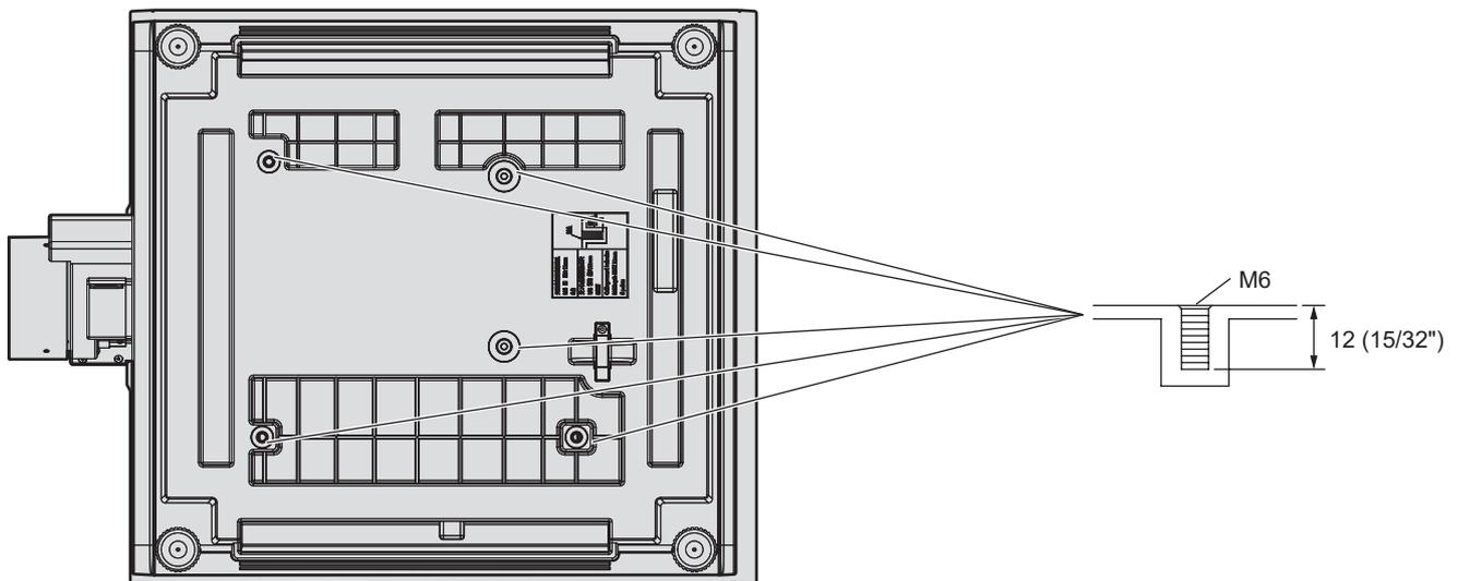
■ Размеры отверстий для винтов для крепления проектора (вид на нижнюю часть проектора)
