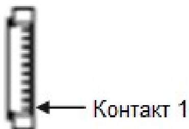
Рисунок 52. Ориентация штырькового 10-ти контактного разъёма двухроторного вентилятора
