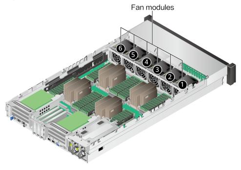
Figure 5-46 Positions of fan modules
