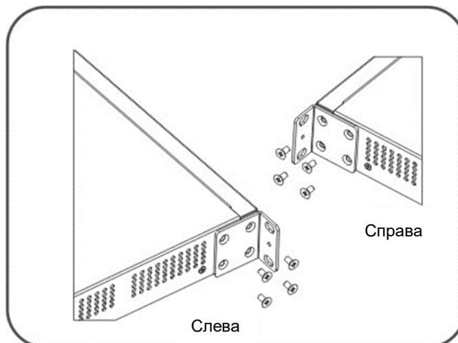
Рисунок 2. Присоединение крепежных кронштейнов к коммутатору
