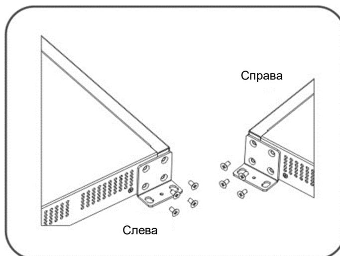
Рисунок 3. Присоединение крепежных кронштейнов к коммутатору для установки на стену
