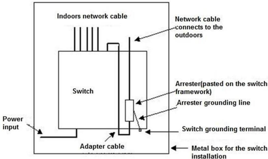
Рисунок 8. Схематическая диаграмма грозоразрядника на Ethernet-порту
