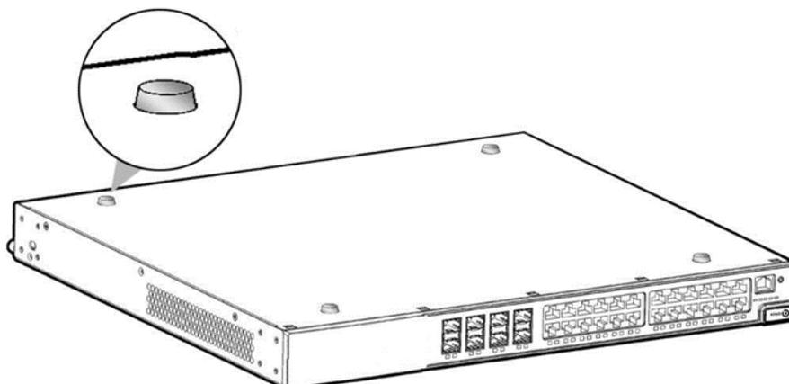
Рисунок 5. Присоединение резиновых ножек к коммутатору
