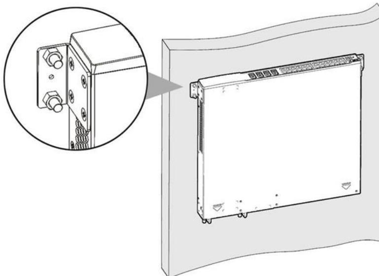
Рисунок 4. Установка коммутатора на стену
