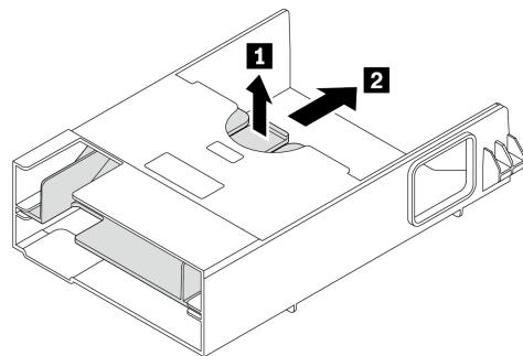
Рис. 127. Снятие центральной пластины
