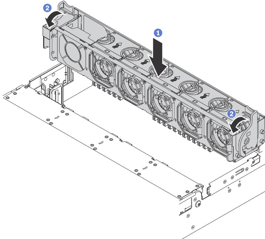
Рис. 136. Установка отсека вентиляторов компьютера
