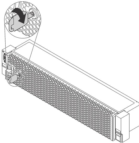
Рис. 98. Разблокирование защитной панели
