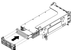
*Рис. 125. Установка держателя графического процессора FHFL*
