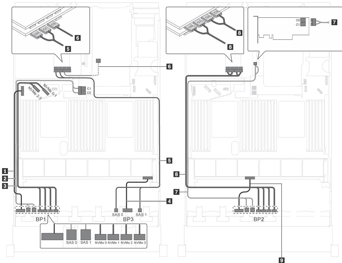
Рис. 76. Прокладка кабелей для моделей серверов с шестнадцатью 2,5-дюймовыми дисками SAS/SATA, восемью 2,5-дюймовыми дисками SAS/SATA/NVMe, задним блоком оперативно заменяемых дисков, двумя адаптерами HBA/RAID 8i, одним адаптером HBA/RAID 16i и одним адаптером-переключателем NVMe
