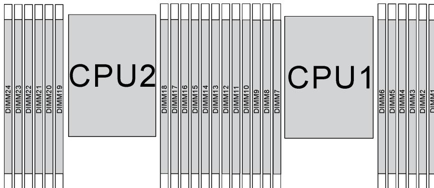
Рис. 107. Гнезда модулей памяти на материнской плате
