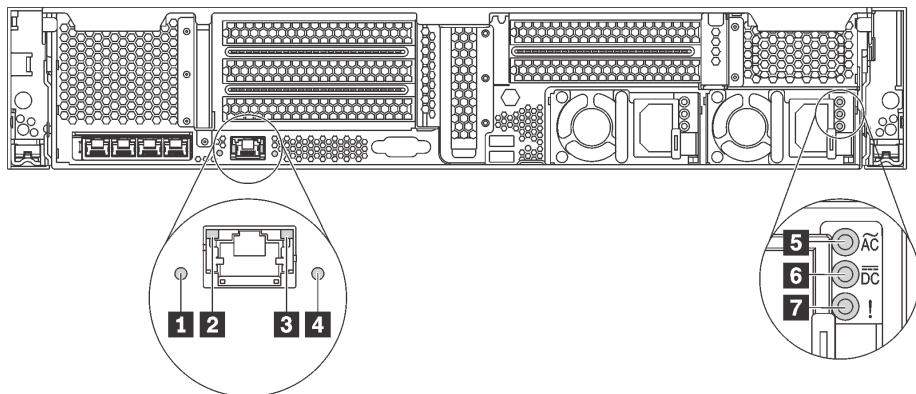
Рис. 14. Светодиодные индикаторы на задней панели сервера
