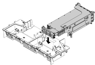
*Рис. 126. Установка двух графических процессоров A10 на одну плату-адаптер Riser*
