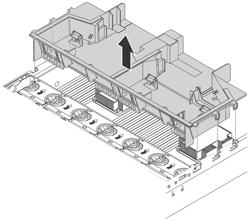
Рис. 102. Снятие дефлектора большого размера
