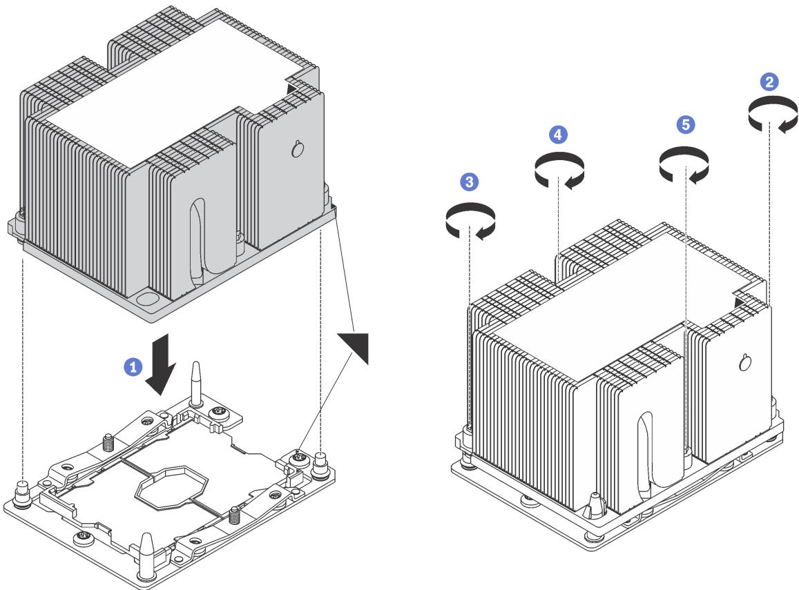
Рис. 104. Установка модуля PHM
