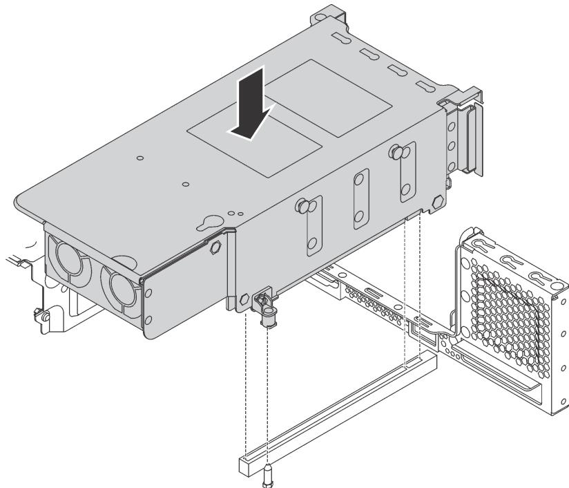
Рис. 112. Установка заднего блока оперативно заменяемых дисков
