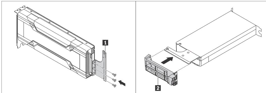
*Рис. 121. Установка скобы и держателя графического процессора*
