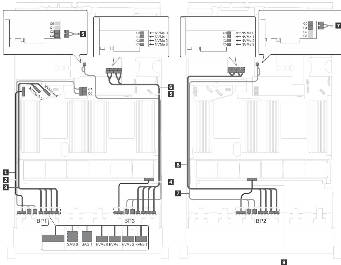
**Рис. 81. Прокладка кабелей для моделей серверов с двенадцатью 2,5-дюймовыми дисками SAS/SATA, двенадцатью 2,5-дюймовыми дисками SAS/SATA/NVMe, одним адаптером HBA/RAID 8i, одним адаптером HBA/RAID 16i и двумя адаптерами-переключателями NVMe**
