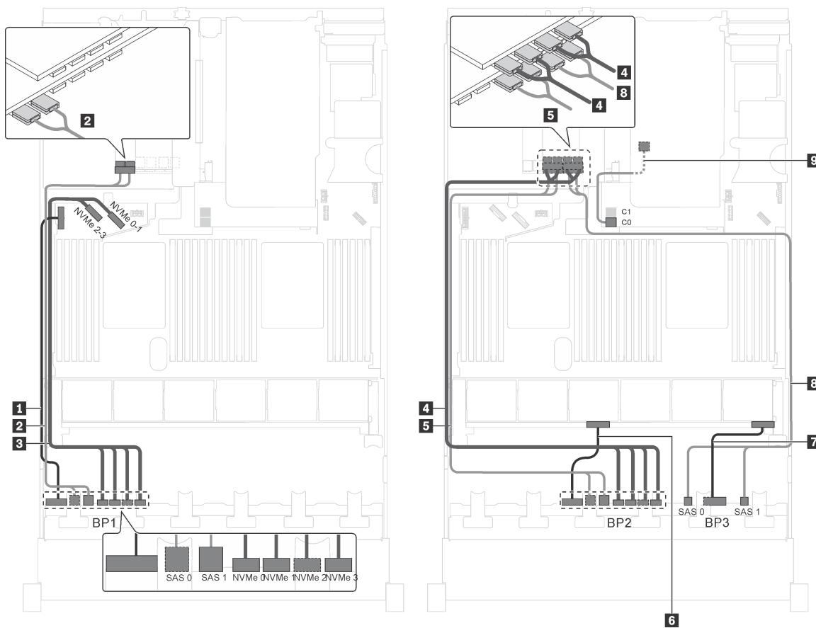
**Рис. 72. Прокладка кабелей для моделей серверов с шестнадцатью 2,5-дюймовыми дисками SAS/SATA, восемью 2,5-дюймовыми дисками SAS/SATA/NVMe, задним блоком оперативно заменяемых дисков, одним адаптером HBA/RAID 8i, одним адаптером RAID 24i и одним адаптером-переключателем NVMe**
