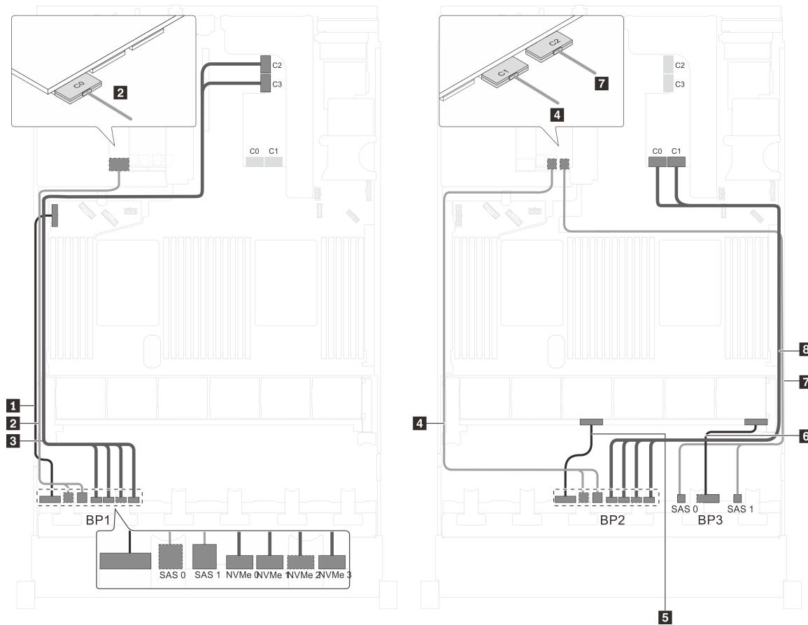
Рис. 71. Прокладка кабелей для моделей серверов с шестнадцатью 2,5-дюймовыми дисками SAS/SATA, восемью 2,5-дюймовыми дисками SAS/SATA/NVMe, одним адаптером HBA/RAID 32i и одним адаптером-переключателем NVMe 1611-8P
