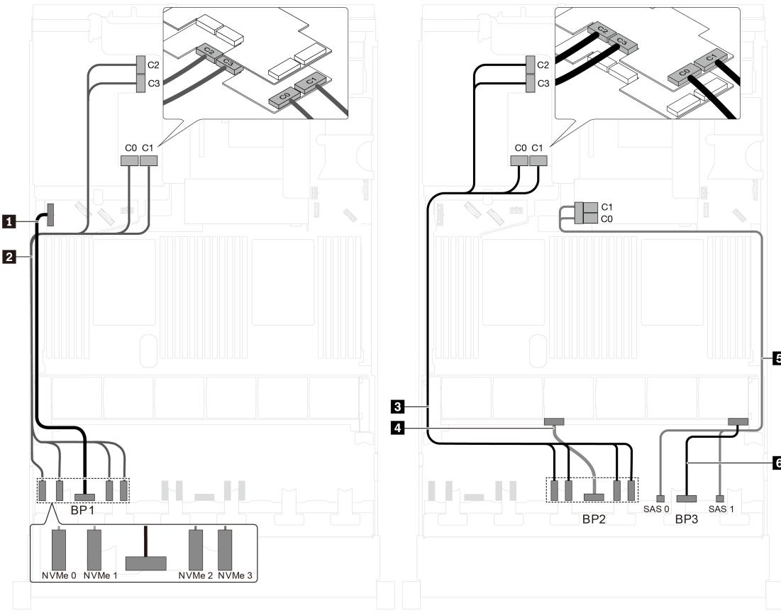
Рис. 84. Прокладка кабелей для моделей серверов с шестнадцатью 2,5-дюймовыми дисками NVMe, восемью 2,5-дюймовыми дисками SAS/SATA, одним адаптером HBA/RAID 8i и двумя адаптерами-переключателями NVMe 1611-8P
