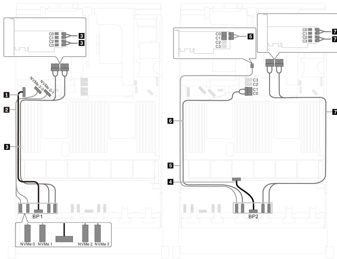
Рис. 50. Прокладка кабелей для моделей серверов с шестнадцатью 2,5-дюймовыми дисками NVMe, двумя адаптерами-переключателями NVMe 810-4Р и двумя адаптерами-переключателями NVMe 1610-4Р
