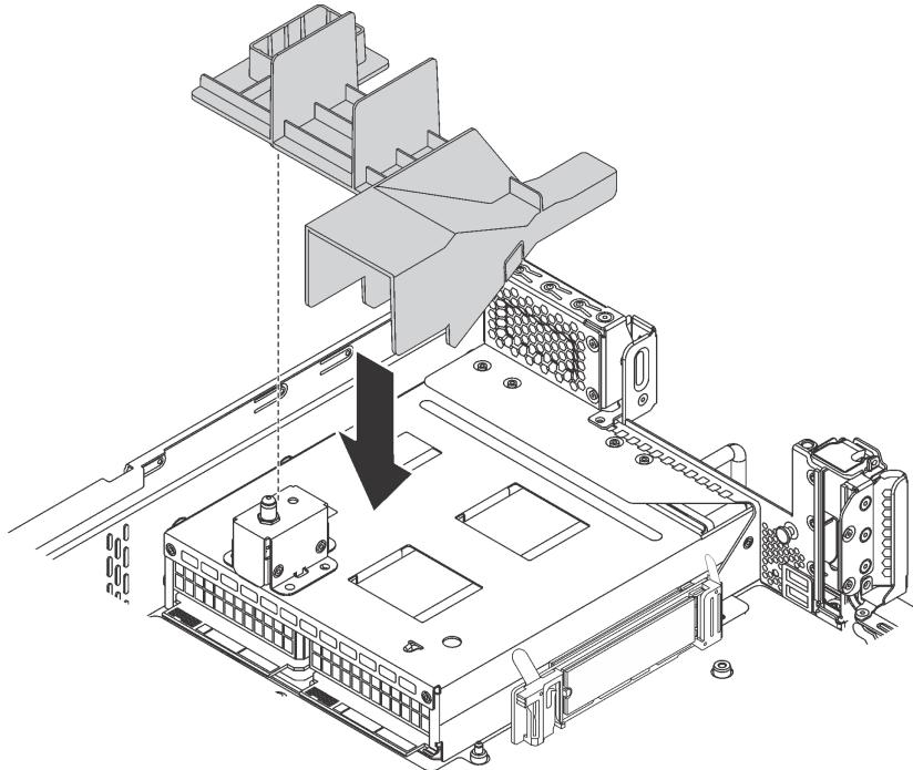
Рис. 118. Установка дефлектора диска M.2
