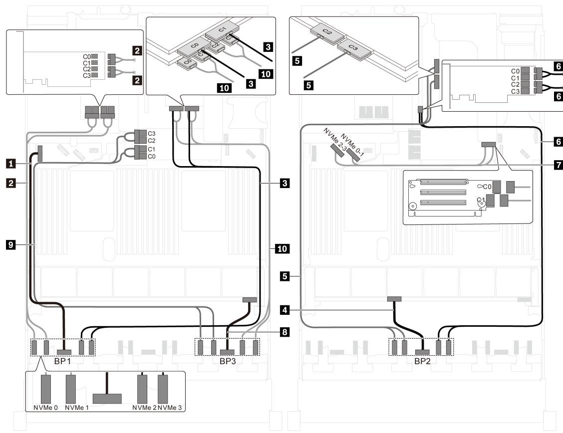
Рис. 85. Прокладка кабелей для моделей серверов с двадцатью четырьмя 2,5-дюймовыми дисками NVMe, четырьмя адаптерами-переключателями NVMe 810-4Р и одним адаптером-переключателем NVMe 1610-8Р
