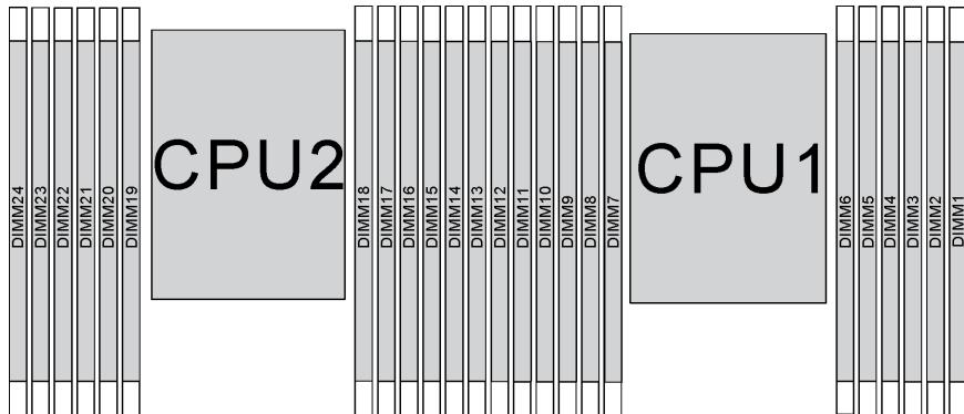
Рис. 106. Гнезда модулей памяти на материнской плате
