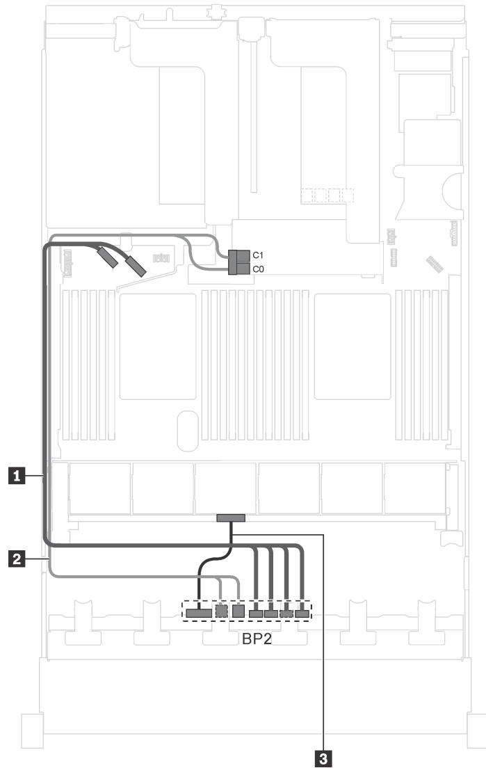
*Рис. 31. Прокладка кабелей для моделей серверов с четырьмя 2,5-дюймовыми дисками SAS/SATA, четырьмя 2,5-дюймовыми дисками SAS/SATA/NVMe, процессорами Intel Xeon 6137, 6242R, 6246R, 6248R, 6250, 6256 или 6258R и одним адаптером HBA/RAID 8i*
