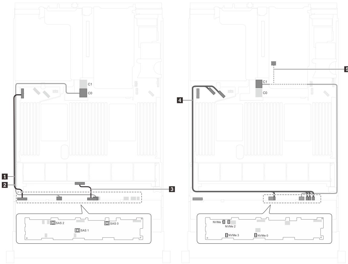
**Рис. 93. Прокладка кабелей для моделей серверов с восемью 3,5-дюймовыми дисками SAS/SATA, четырьмя 3,5-дюймовыми дисками SAS/SATA/NVMe, задним блоком оперативно заменяемых дисков и одним адаптером HBA/RAID 16i Gen 4**
