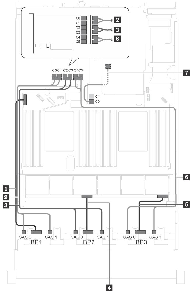
Рис. 58. Прокладка кабелей для моделей серверов с двадцатью четырьмя 2,5-дюймовыми дисками SAS/SATA, задним блоком оперативно заменяемых дисков, одним адаптером HBA/RAID 8i и одним адаптером RAID 24i
