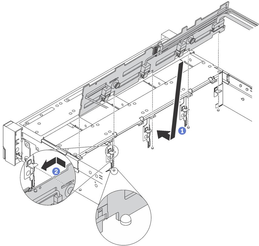
Рис. 110. Установка объединительной панели для 3,5-дюймовых дисков
