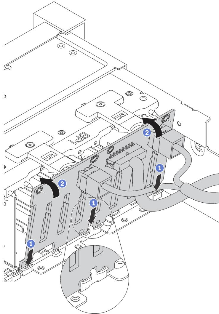
Рис. 108. Установка объединительной панели для 2,5-дюймовых дисков
