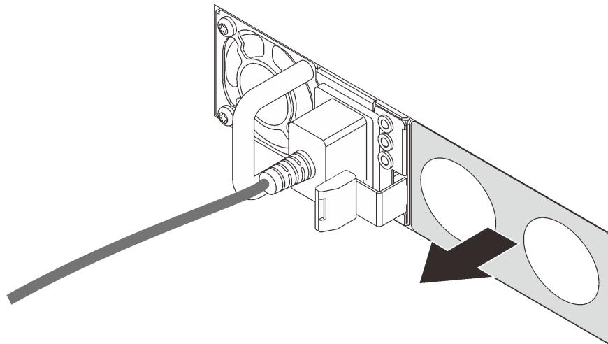
Рис. 139. Снятие заглушки оперативно заменяемого блока питания
