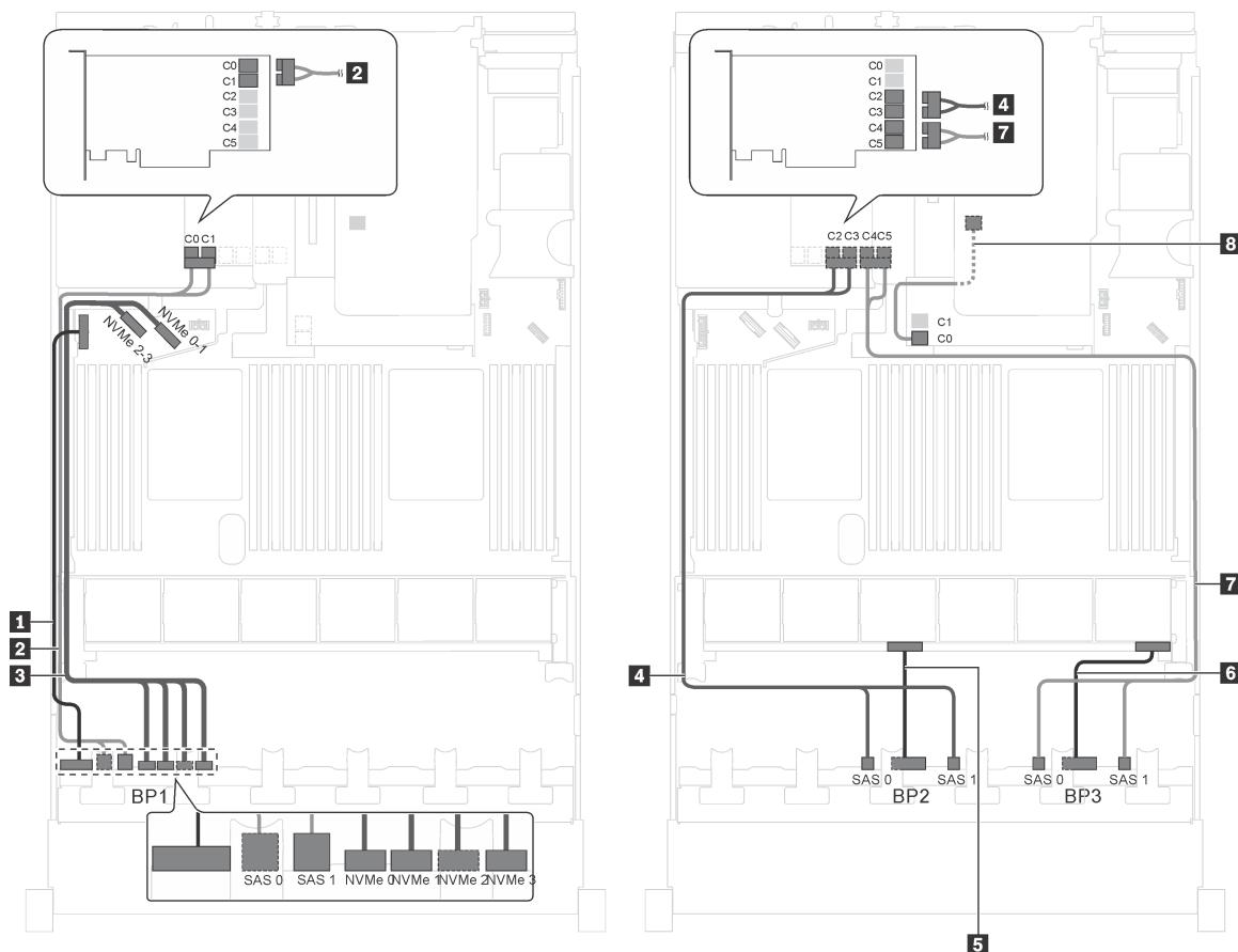
**Рис. 66. Прокладка кабелей для моделей серверов с двадцатью 2,5-дюймовыми дисками SAS/SATA, четырьмя 2,5-дюймовыми дисками SAS/SATA/NVMe, задним блоком оперативно заменяемых дисков, одним адаптером HBA/RAID 8i и одним адаптером RAID 24i**
