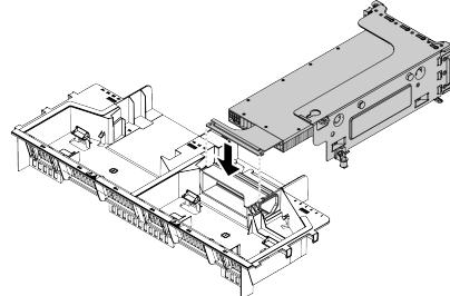
*Рис. 124. Установка одного графического процессора A10*
