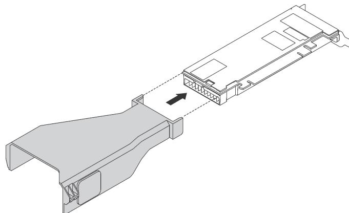
*Рис. 122. Установка дефлектора графического процессора P4*
