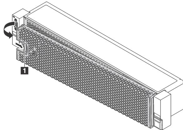
Рис. 99. Снятие защитной панели
