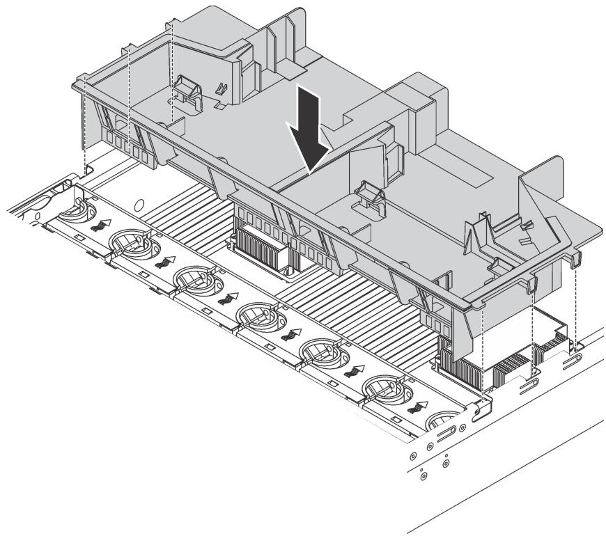
Рис. 142. Установка дефлектора большого размера
