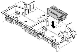
*Рис. 123. Установка дефлектора графического процессора A10*
