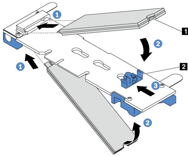
Рис. 115. Установка диска M.2
