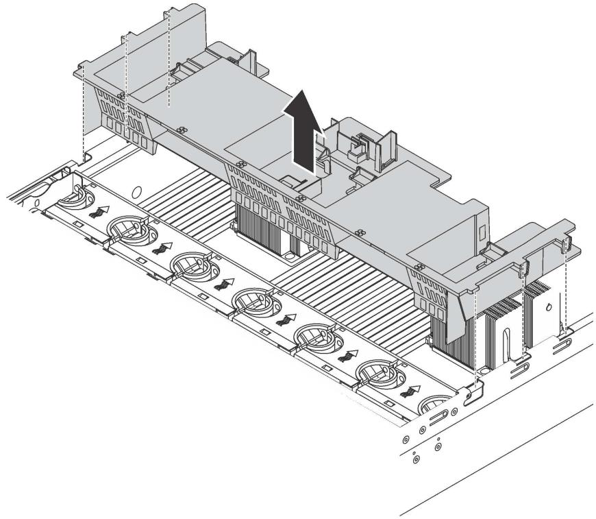
Рис. 101. Снятие стандартного дефлектора
