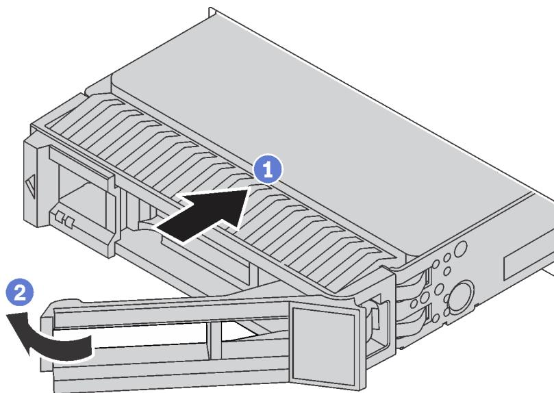
Рис. 148. Установка 3,5-дюймового оперативно заменяемого диска
