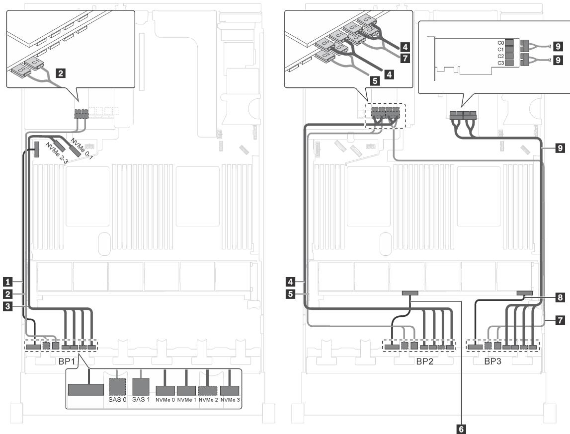
Рис. 77. Прокладка кабелей для моделей серверов с двенадцатью 2,5-дюймовыми дисками SAS/SATA, двенадцатью 2,5-дюймовыми дисками SAS/SATA/NVMe, одним адаптером RAID 24i и двумя адаптерами-переключателями NVMe
