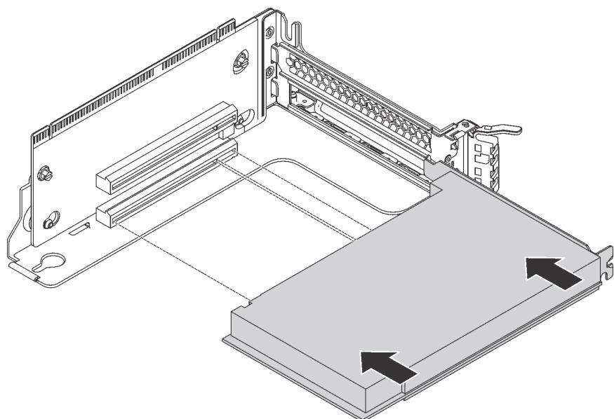
Рис. 129. Установка адаптера PCIe
