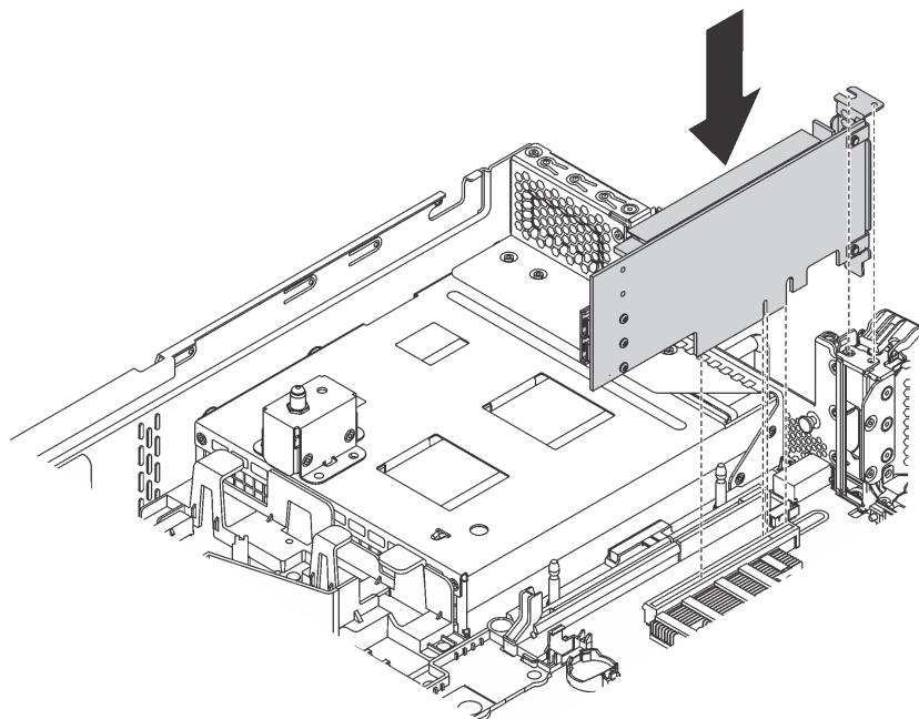
Рис. 133. Установка адаптера PCIe на материнскую плату
