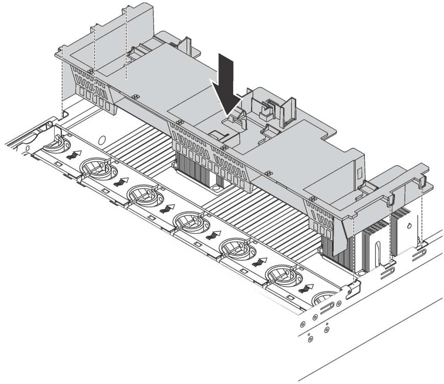
Рис. 141. Установка стандартного дефлектора
