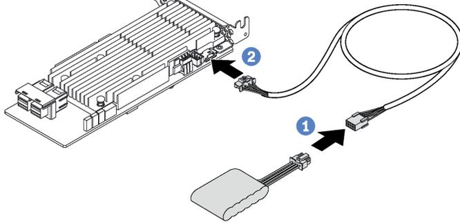
Рис. 63. Подключение модуля суперконденсатора RAID к адаптеру RAID
