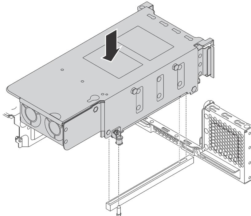
Рис. 41. Установка заднего блока оперативно заменяемых дисков
