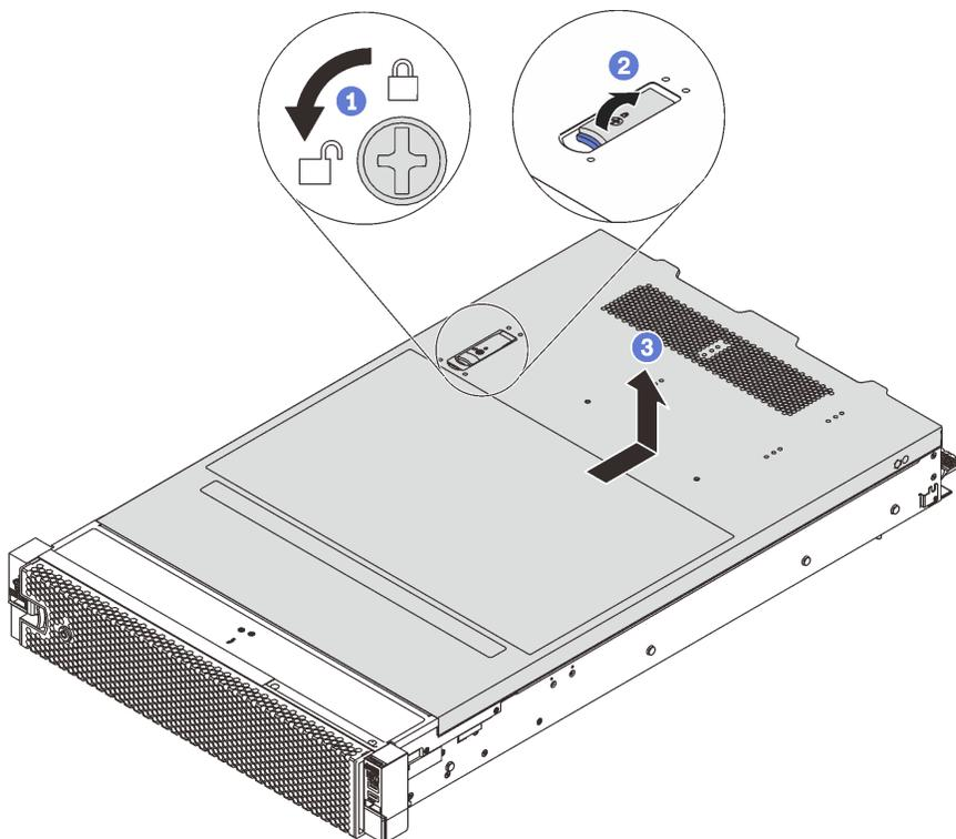
Рис. 31. Снятие верхнего кожуха
