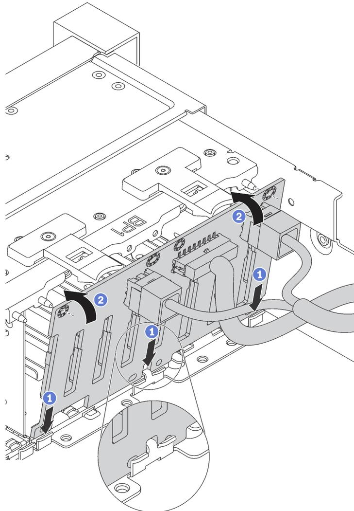
Рис. 37. Установка объединительной панели для 2,5-дюймовых дисков
