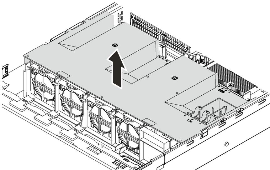
Рис. 32. Снятие дефлектора
