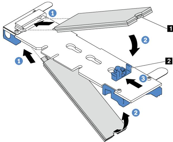
Рис. 44. Установка диска M.2
