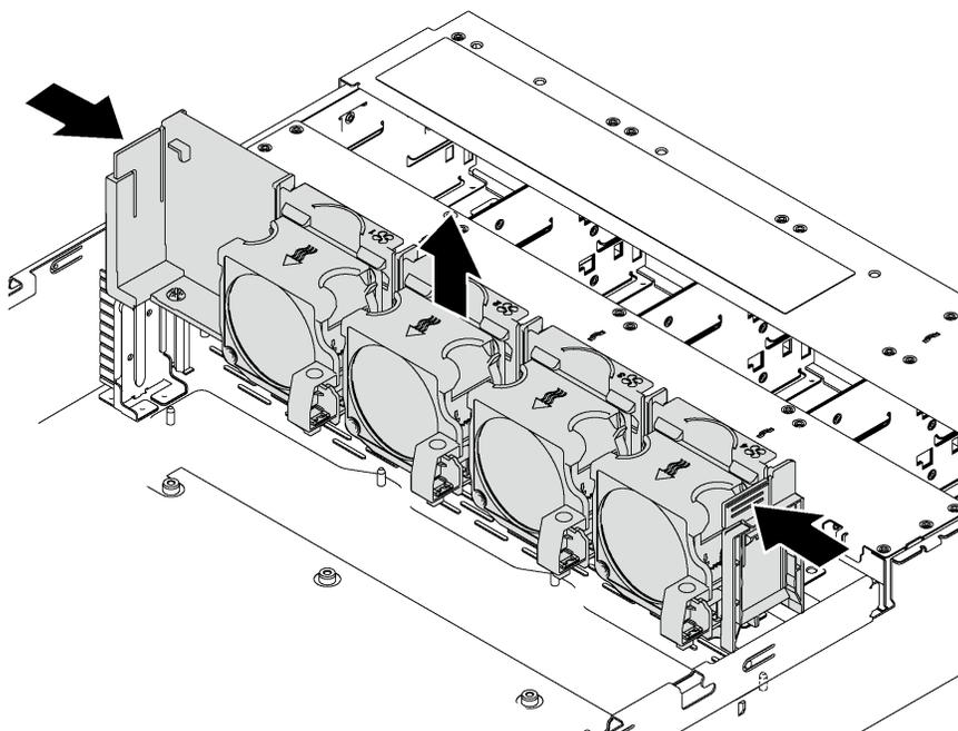
Рис. 33. Снятие отсека вентиляторов компьютера
