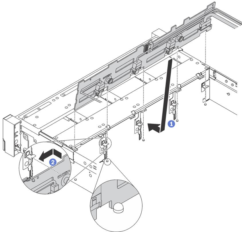
Рис. 39. Установка объединительной панели для 3,5-дюймовых дисков
