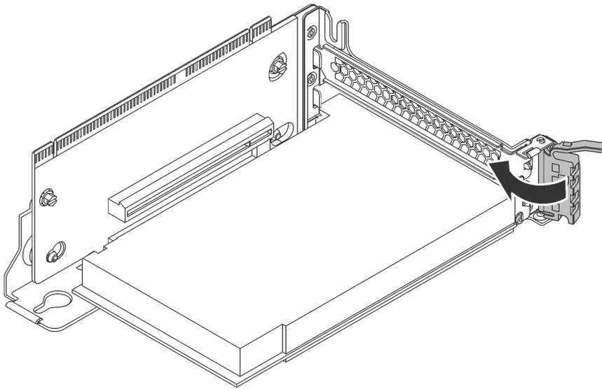
Рис. 50. Закрывание фиксирующей защелки PCIe
