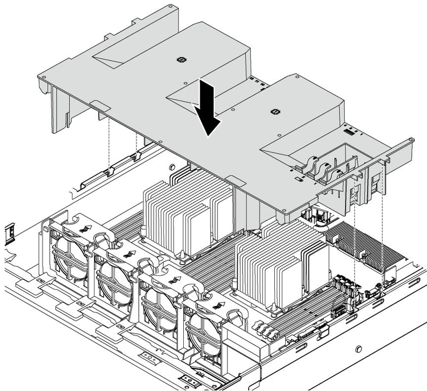
Рис. 61. Установка дефлектора
