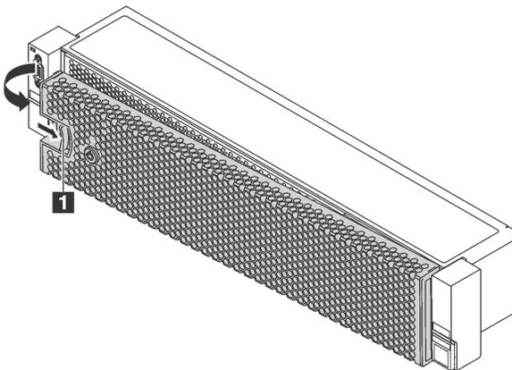
Рис. 30. Снятие защитной панели
