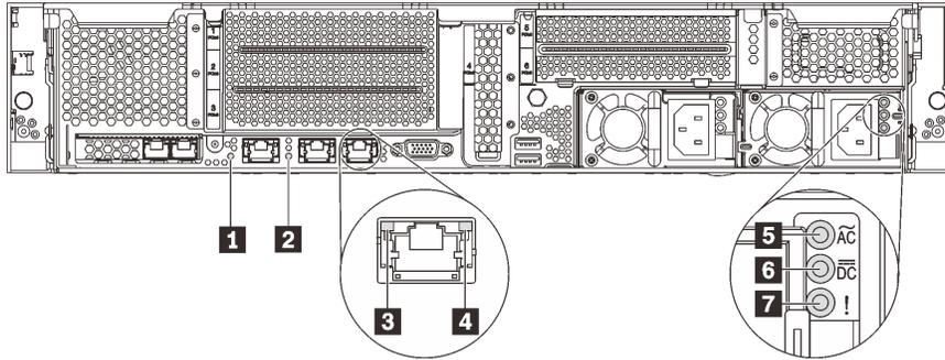
Рис. 12. Светодиодные индикаторы на задней панели сервера
