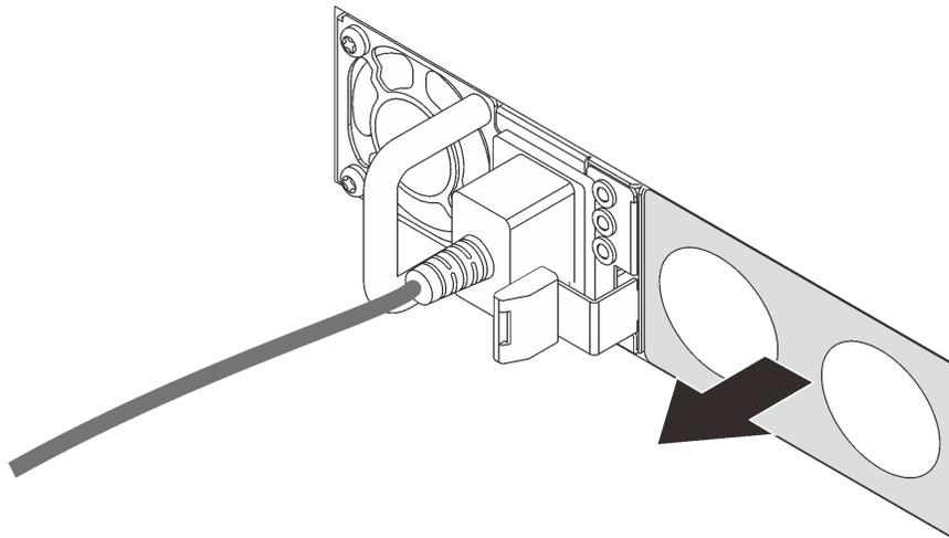
Рис. 59. Снятие заглушки оперативно заменяемого блока питания
