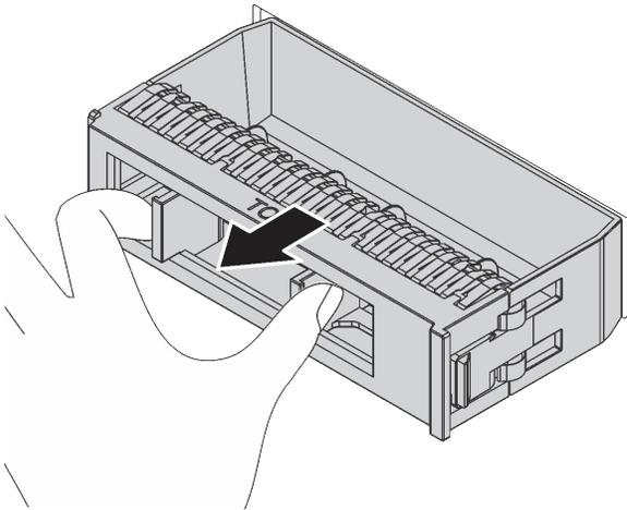
Рис. 67. Снятие заглушки 3,5-дюймового диска
