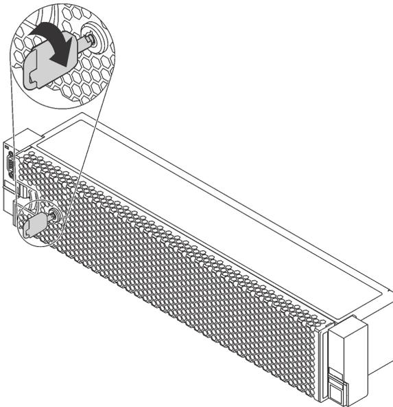
Рис. 29. Разблокирование защитной панели
