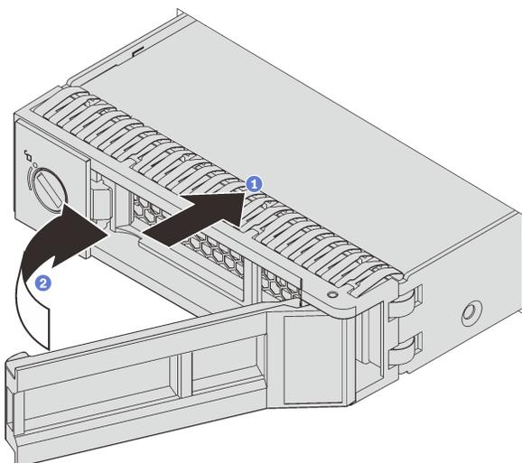
Рис. 71. Установка диска с обычной заменой
