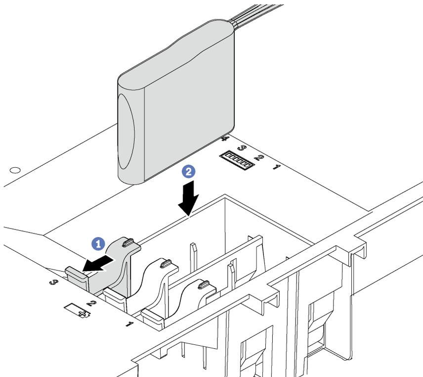
Рис. 62. Установка модуля суперконденсатора RAID
