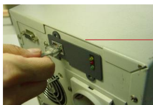
Рисунок 5 – Установка SNMP карты в ИБП
