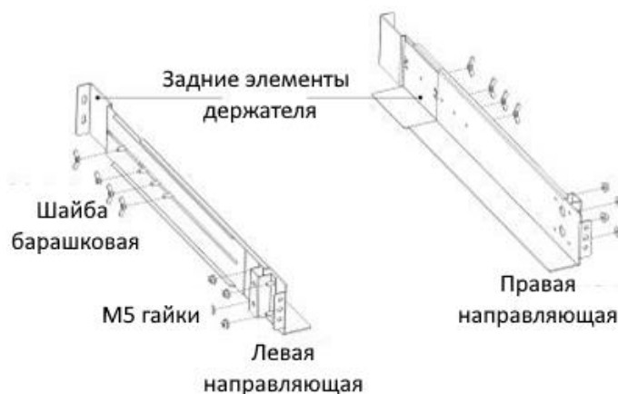
Рисунок 3. Крепление монтажного комплекта рельс
